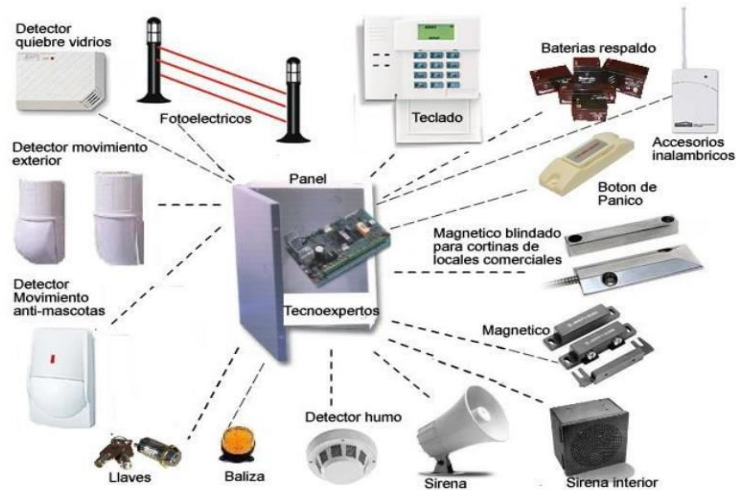
Fig. II. 8 Sistemas de Alarmas de Seguridad
