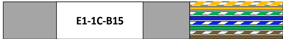
Figura 10. Etiquetado de cable de datos en clase 3
