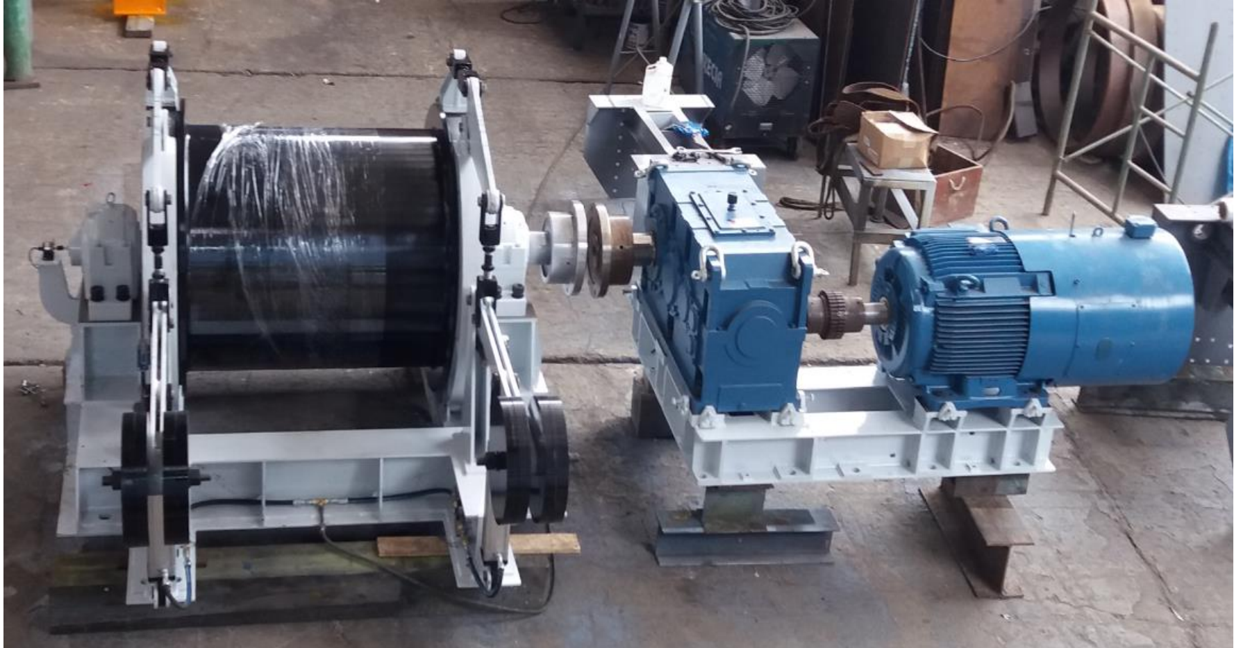
Fuente propia. Winche de izaje Minera Sotrami S.A.
