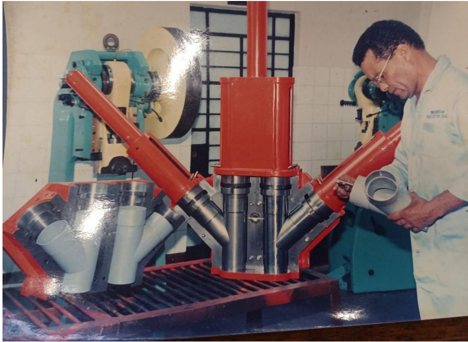
Figura 13. Molde de 4" YEE para conexiones de PVC de 2 cavidades pistones hidraulicos.
