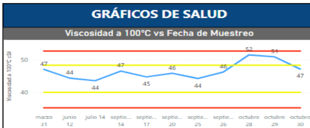
Figura. 4.26 Resultados de salud del lubricante: Viscosidad. Prueba.
