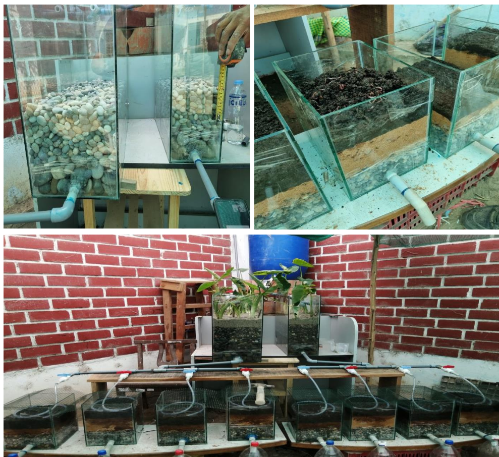
Figura 3. Construcción del prototipo acoplado Wetland y Tohá.
