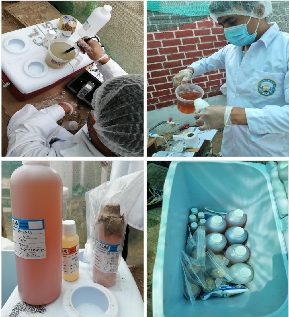
Figura 6. Muestreo de agua residual en el afluente y efluentes
