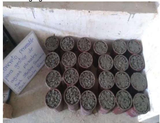
Probetas con concreto permeable a los 28 días de edad al 10% de agregado fino
