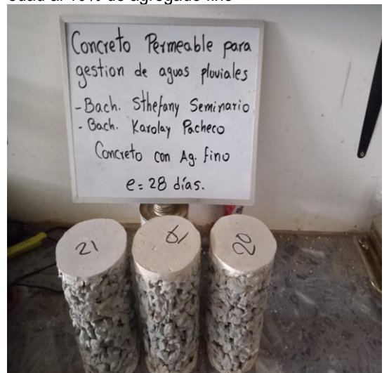
Probetas con concreto permeable a los 28 días de edad al 10% de agregado fino
