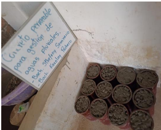
Probetas con concreto permeable a los 28 días de edad al 0% de agregado fino
