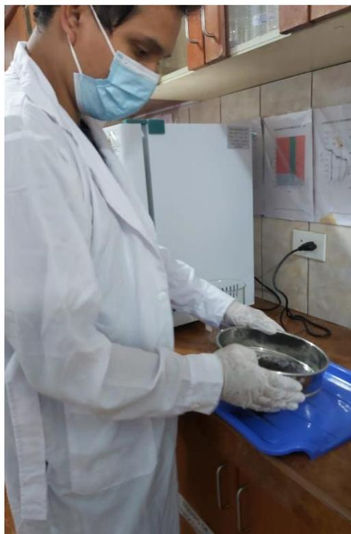
**Anexo 9 Registro fotográfico del proceso de pesado de la dosis de biocarbón y su aplicación sobre la muestra de agua ácida**
