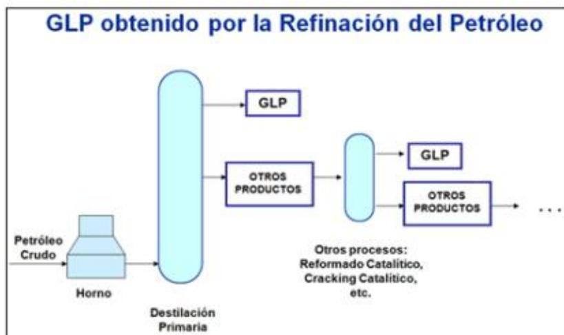
Figura N° 2. 5. Esquema Simplificado de Obtención de Glp a partir del gas
