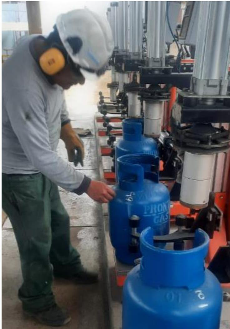
*Figura N° 1. 8. Colocación de Tara de Cilindros*
