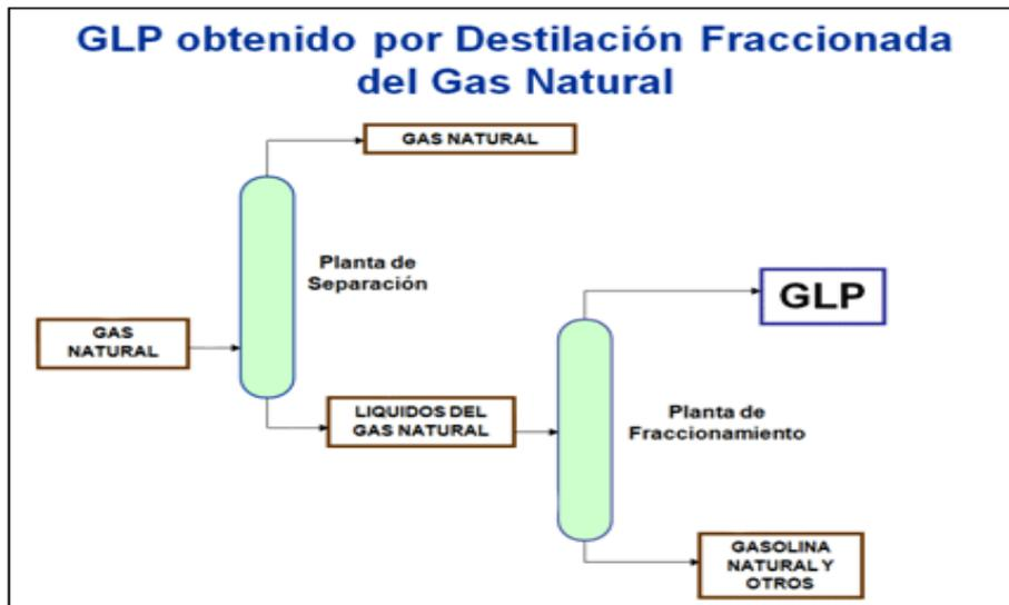
Figura N° 2. 4. Esquema Simplificado de Obtención de Glp a partir del Petróleo.
