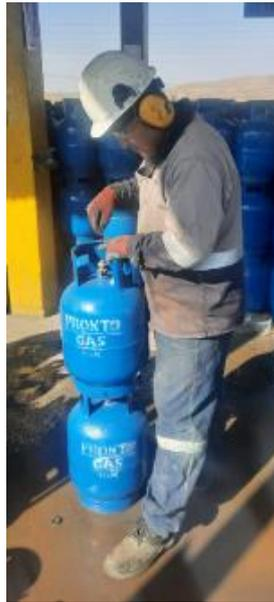
*Figura N° 1. 12. Prueba de Fugas de Cilindros Llenos*
