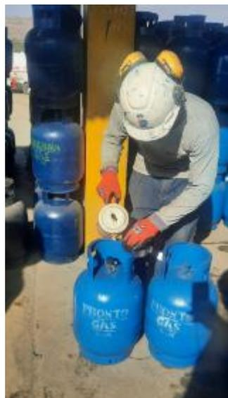
*Figura N° 1. 13. Precintado de Cilindros Llenos*
