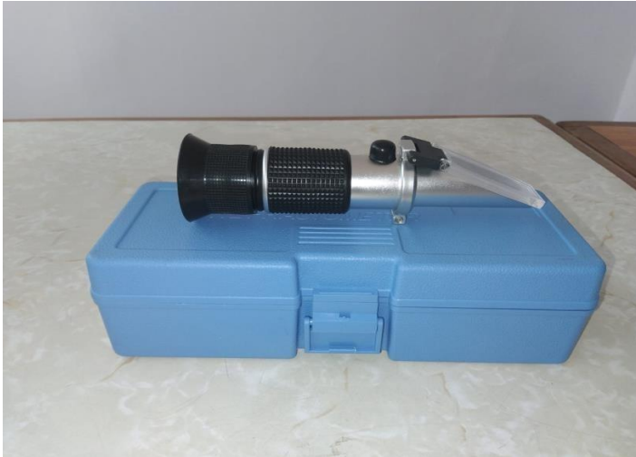
Figura N° 15 Refractómetro utilizado en las pruebas (0-32 grados brix)
