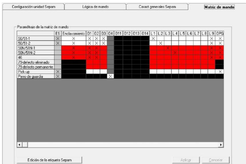
Figura 14. Funciones activadas en relé de protección de la celda de salida
