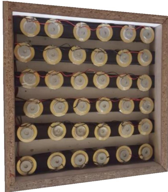
Figura 19. Sistema interno de la baldosa piezoeléctrica
