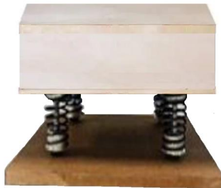
Figura 18. Sistema mecánico externo de la baldosa piezoeléctrica
