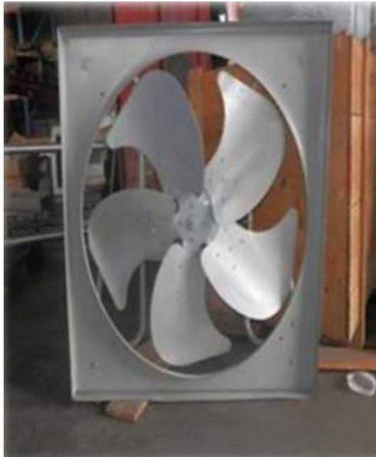
**Figura 6. Fabricación de extractor**
