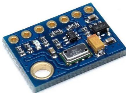
Figura N°28 Modulo Barómetro MS5611.
