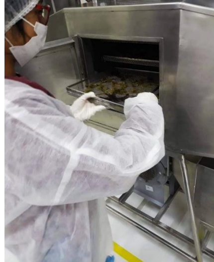
FIGURA 7: Alimentación del secador convectivo.
