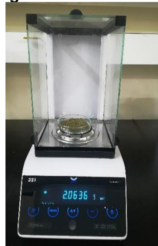
FIGURA 6: Pesado de placa luego de humedad en mufla.
