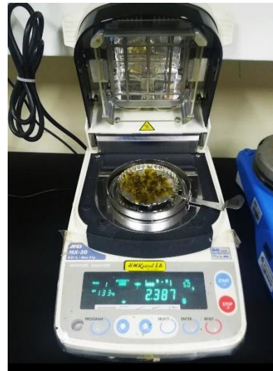
FIGURA 4: Determinación de humedad en balanza de humedad
