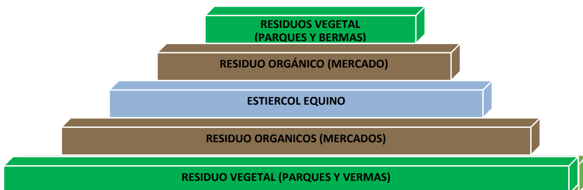
Figura 58. Distribución de los residuos orgánicos en una pila de compostaje.
