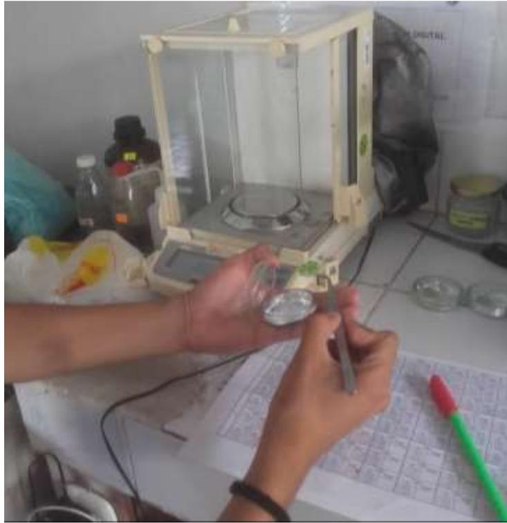
*Proceso de determinación de la masa de la microalga después del secado de 24h*
