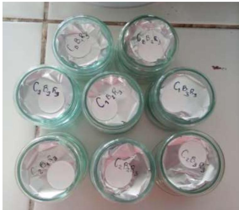
*Filtros listos para el proceso de filtración de la muestra*
