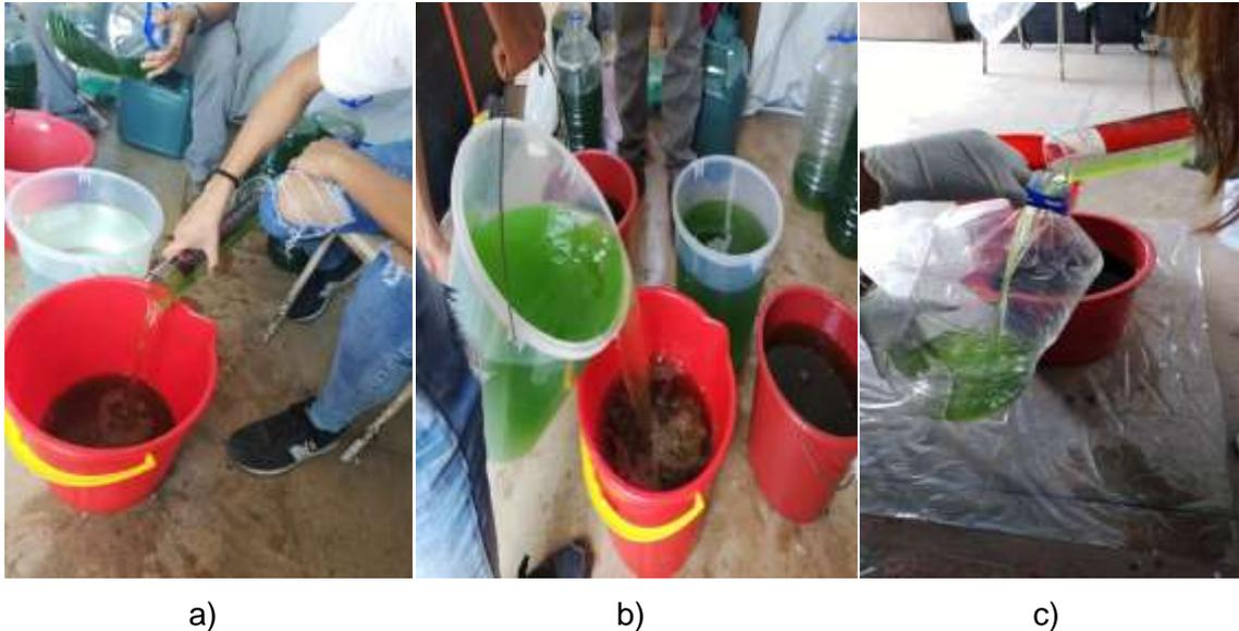
*Nota.* a) Dilución de la microalga concentrada, b) Mezcla de microalga con agua previamente tratada en proporción 1:1, c) Inoculación de microalgas en las unidades experimentales.
