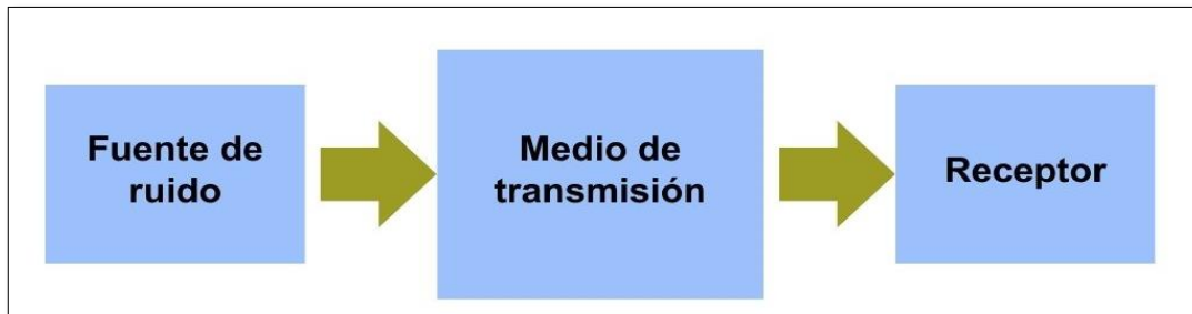
Figura 1. Propagación del ruido. El esquema muestra a la Fuente (Representa a una o varias fuentes de ruido en este caso al tránsito aéreo), Medio (El medio puede ser de distintos tipos) y al Receptor (Constituye un individuo o grupo de individuos cuya actividad se ven alteradas por la presencia de ruido). Adaptado de(Fuentes 2019).
