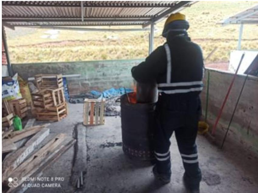
Después de la obtención del biocarbón, se retiró del horno de doble tambor y se extendió sobre una superficie para su enfriamiento durante un período de 2 horas a temperatura ambiente.
