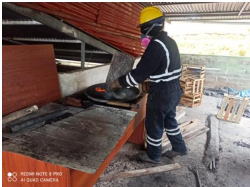
Luego, se llevó a cabo la trituración del biocarbón obtenido, con el fin de homogenizar su tamaño en partículas finas. Este biocarbón se almacenó en bolsas para su utilización en las pruebas experimentales.
