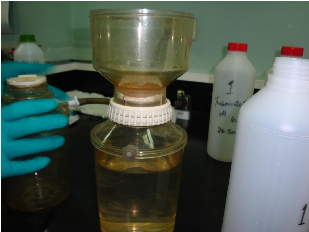
Figura N° 3.4 REPRESENTACIÓN DETALLADA DE LA FILTRACIÓN.
