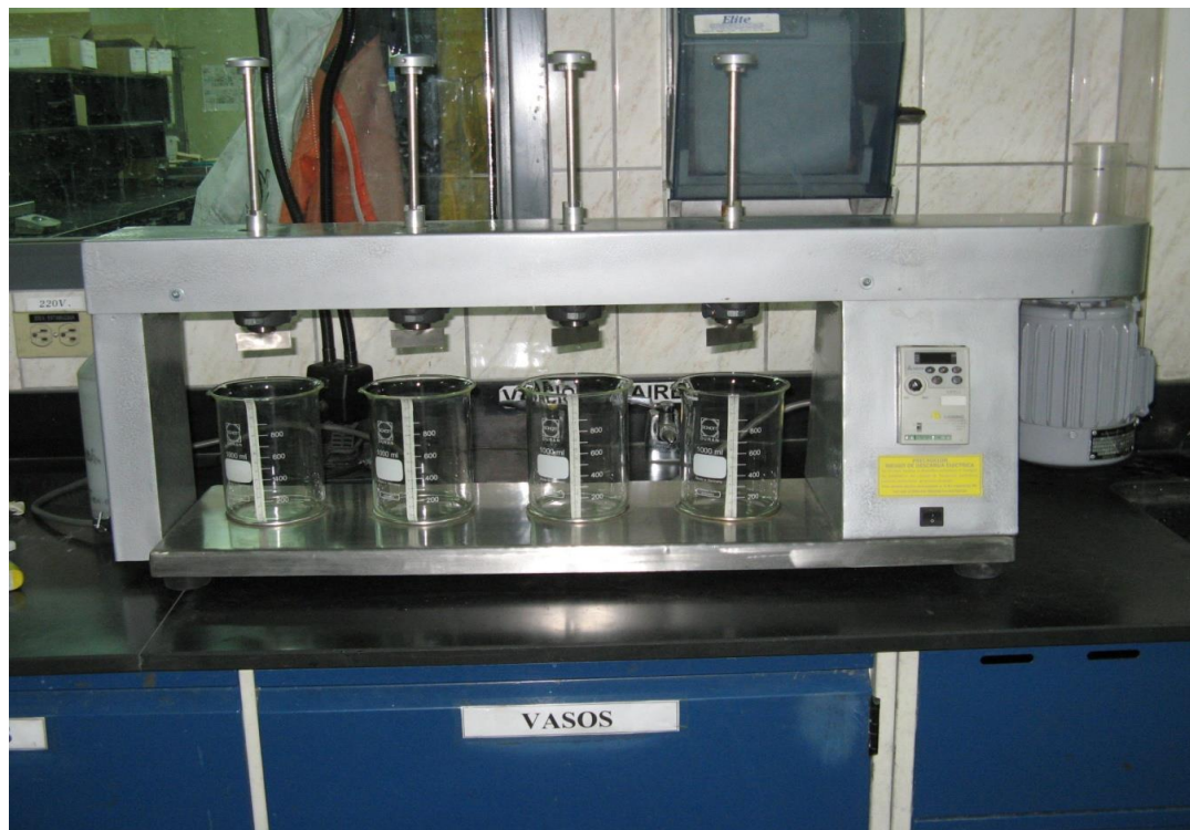
Figura N° 3.1 REPRESENTACIÓN DETALLADA DEL EQUIPO DE JARRAS (FLOCULADOR-SEDIMENTADOR)
