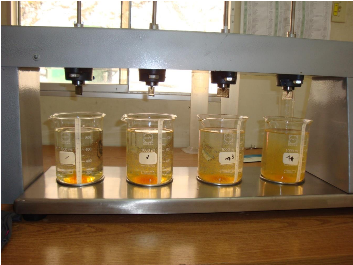
Figura N° 3.3 REPRESENTACIÓN DETALLADA DE LA SEDIMENTACIÓN.
