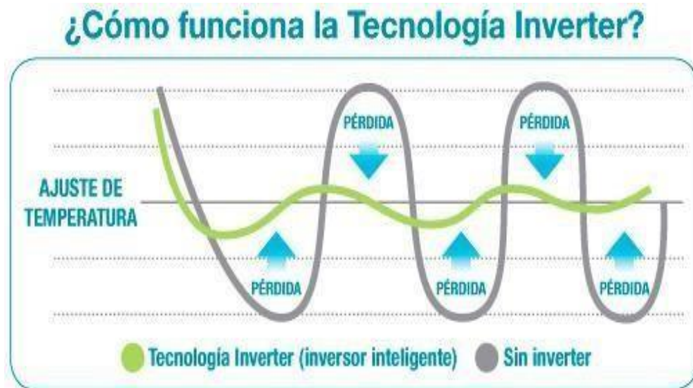
Figura 4.1 ESQUEMA DE FUNCIONAMIENTO DE TECNOLOGIA INVERTER
