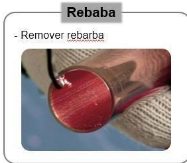
Figura 4.29 PROCESO DE REMOSION DE REBABA EN LA TUBERIA
