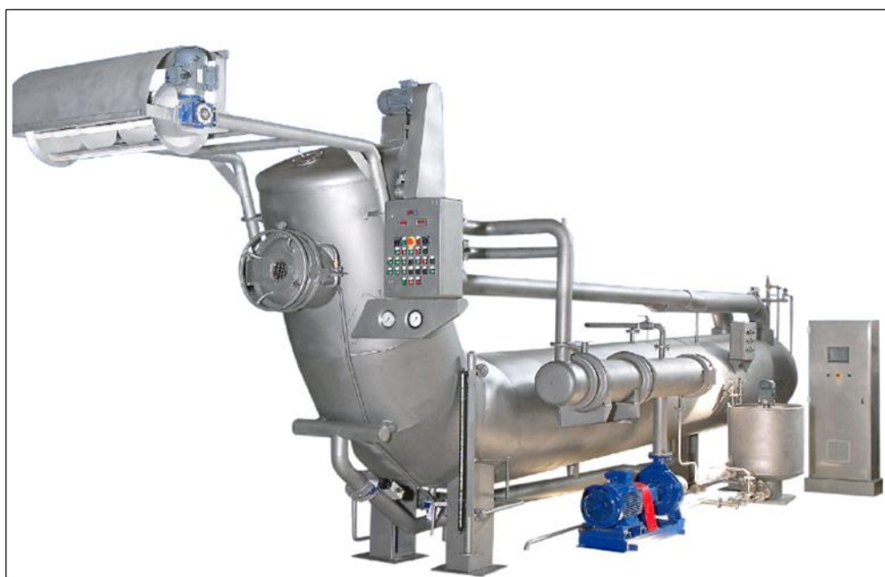
Figura 15 Autoclave para Teñido de Telas Sintéticas a Altas Temperaturas
