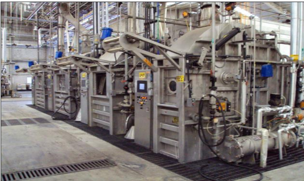
Figura 14 Barca para Teñido en Cuerda a Baja Presión
