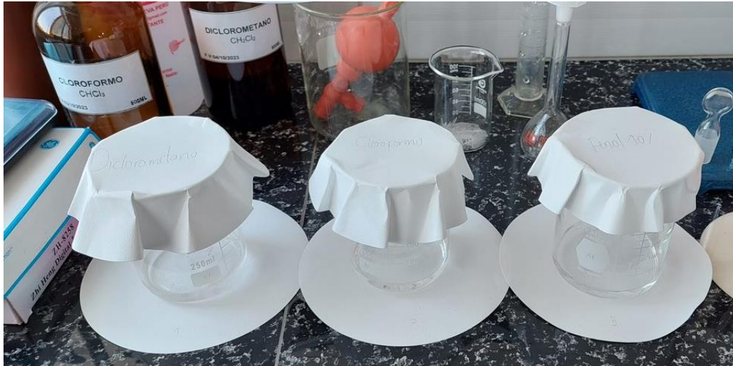
Figura 11 Dilución de discos compactos en solventes
