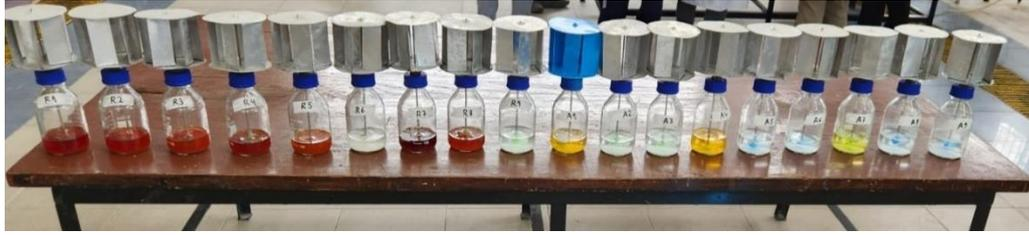
En la Figura 12 se observa las soluciones en los las soluciones contenidas en los reactores R10, R11, R12 y A10, A11, A12, cuya dosificación se realizó en base a un diseño. Las soluciones contenidas en los reactores R13 y A13 contiene solo la solución acuosa de ambos colorantes a la concentración de 1000 ppm de colorante.
