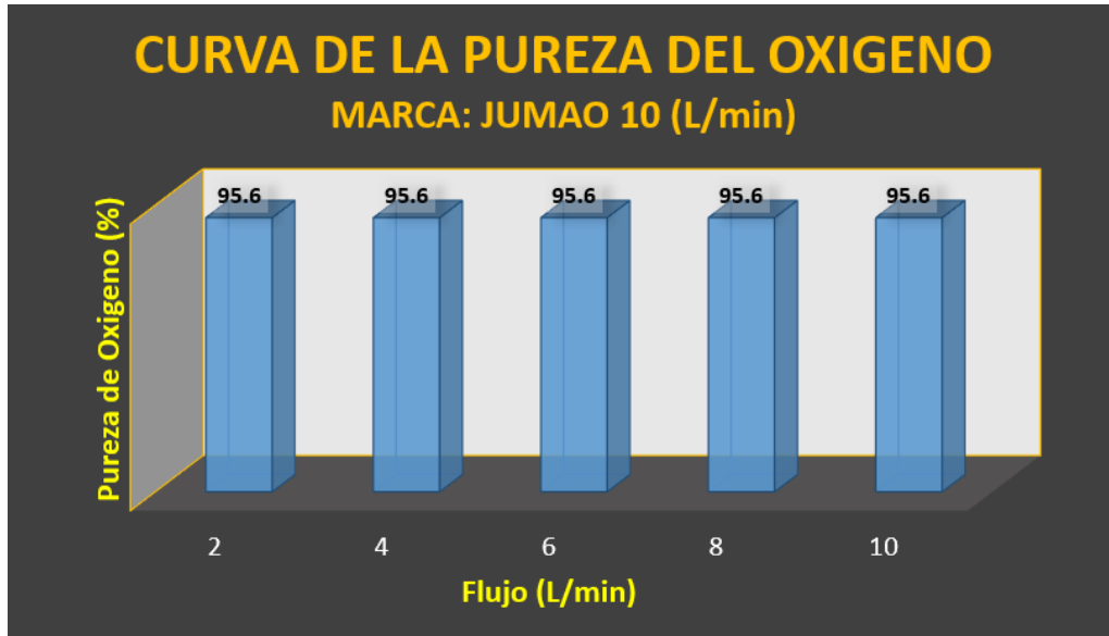
Figura N° 4. La Grafica del porcentaje de pureza (%) en función del flujo (L/min) del generador de oxígeno Jumao.
