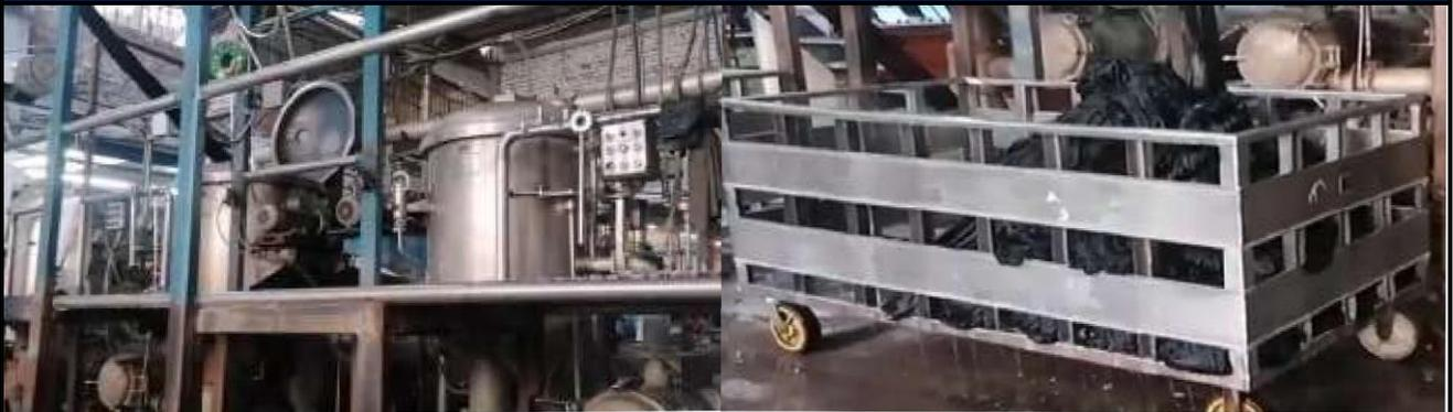
En este proceso hay tres personales que se encargan de colocar las telas en los autoclaves que son como ollas a presión, en cada una puedes meter hasta 130 kilos de tela, una vez dentro de los enclaves se pone colorante , agua caliente y se tiñe. El trascurso de teñido dura cuatro horas.
