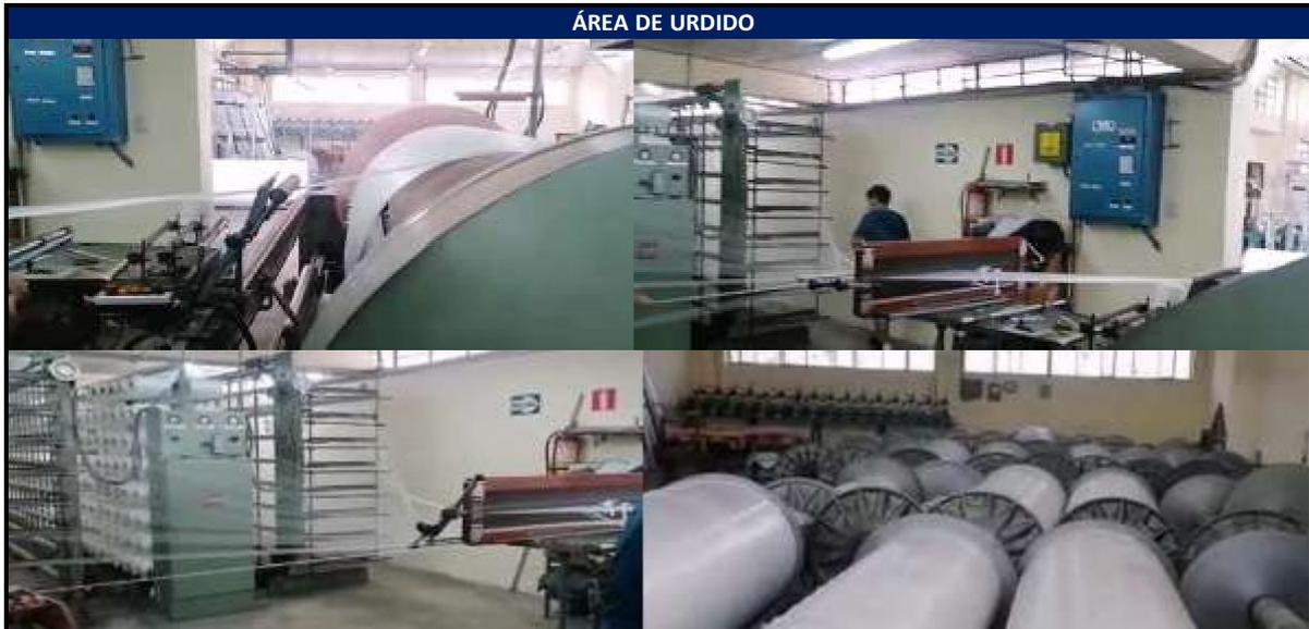
En esta área hay un solo operario que maneja la máquina urdidora, en este proceso se instala el hilo de los conos pequeños desplazando paralelamente al eje de rotación en el cual se pueden conducir los hilos sobre el tambor urdidor, el proceso de hilos al carrete tarda 24 horas.
