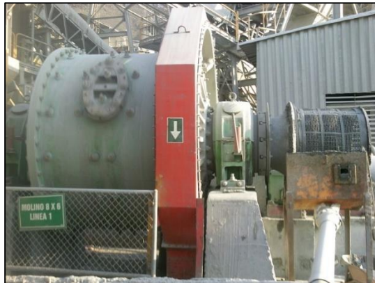
Figura 2.34 Molino de bolas primario – 8x6L1 (M1)
