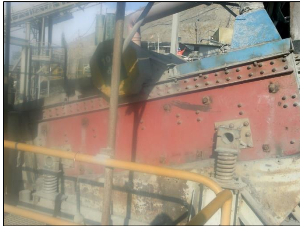
Figura 2.31 Zaranda vibratoria Roxón MSO20-1030 DD (Z2)
