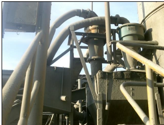
Figura 2.35 Hidrociclón Cávex – 400/ Krebs – L1 (H1)
