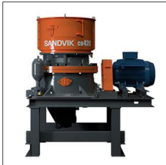
Figura 2.4 Modelo de chancadora cónica CH420
