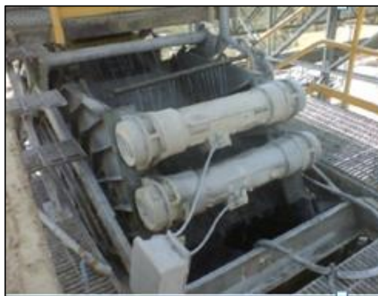
Figura 2.36 Cedazo de alta frecuencia Derrick 4 Deck (Z5)
