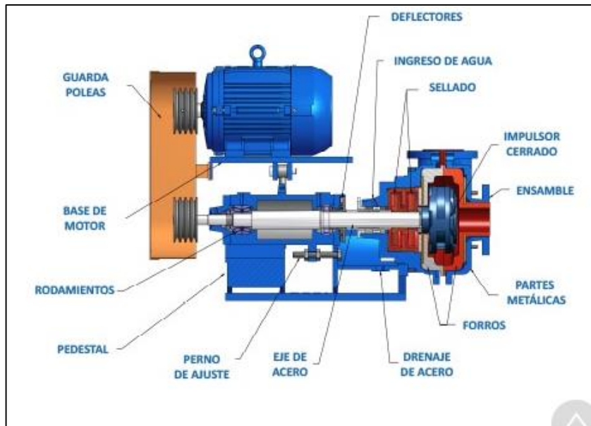
Figura 2.22 Partes de bomba horizontal S.S.
