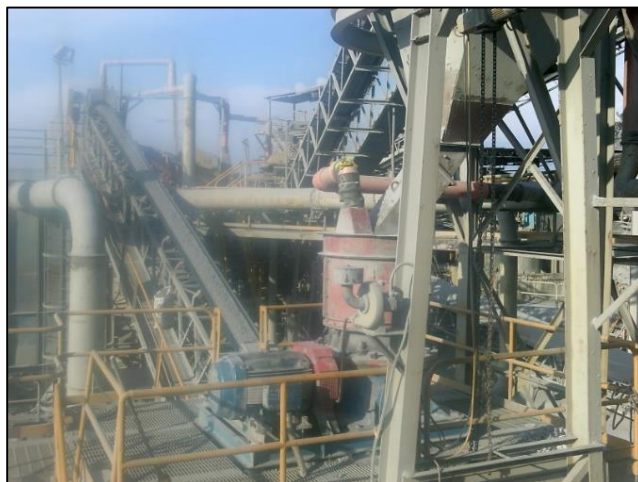
Figura 2.32 Chancadora cónica terciaria (CH4)
