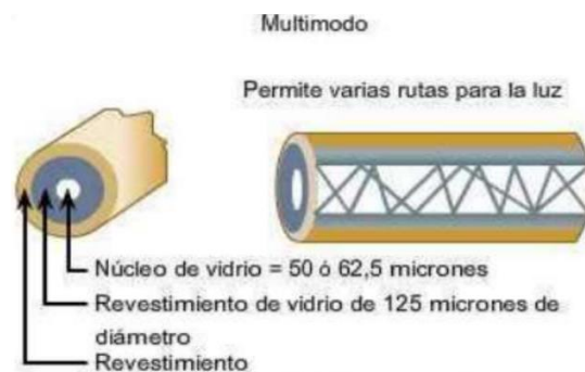
Figura 7. Estructura de la fibra óptica Multimodo
