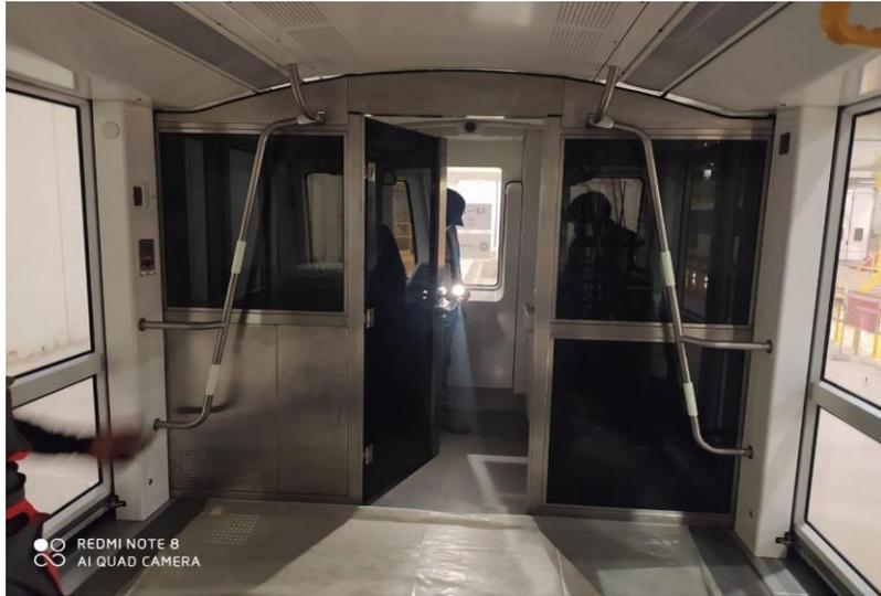
**a. Montaje de casco de estructura en acero inoxidable de gabinete**
