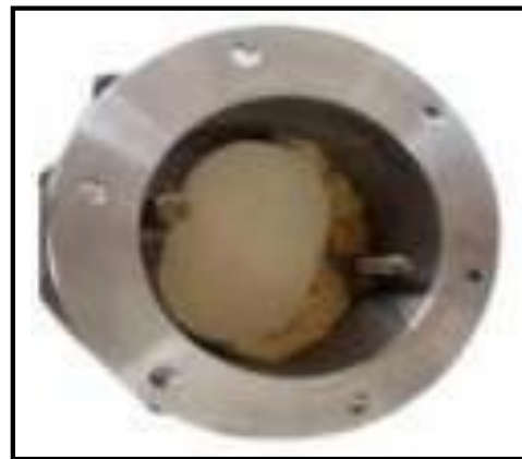
(d) Cápsula con dos monolitos
