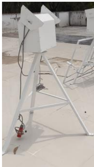
Figura 36. Soporte estructural del seguidor de 2 ejes
