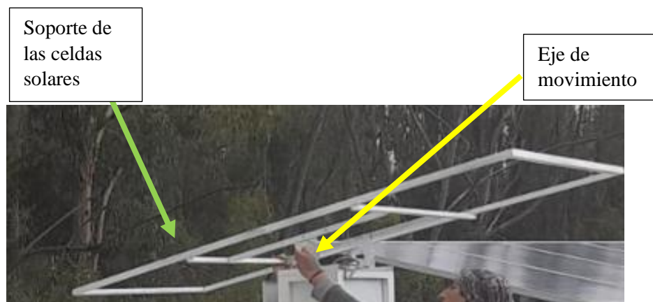
Figura 33. Soporte de las celdas solares a lo largo del eje de movimiento
