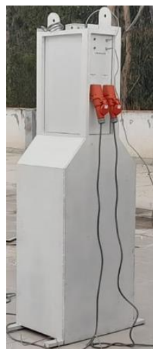
Figura 31. Soporte estructural del seguidor solar de 1 eje
