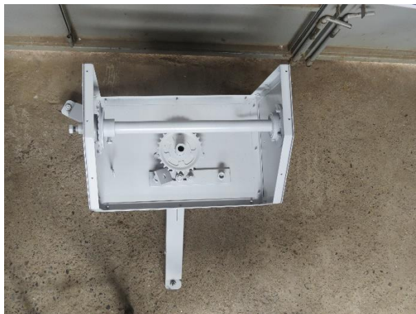
Figura 52. Armado del seguidor de 2 ejes y astronómico
