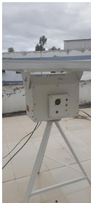
Figura 38. Panel de control del seguidor de 2 ejes
