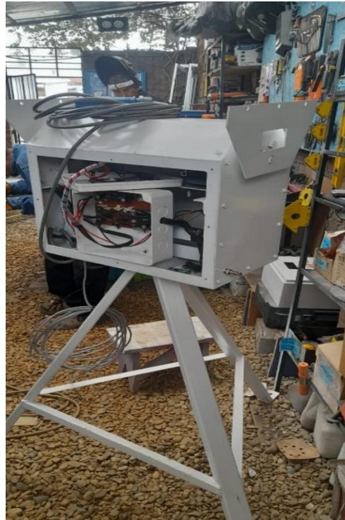
EN SAMBLAJE DE SEGUIDOR SOLAR DE UN EJE
