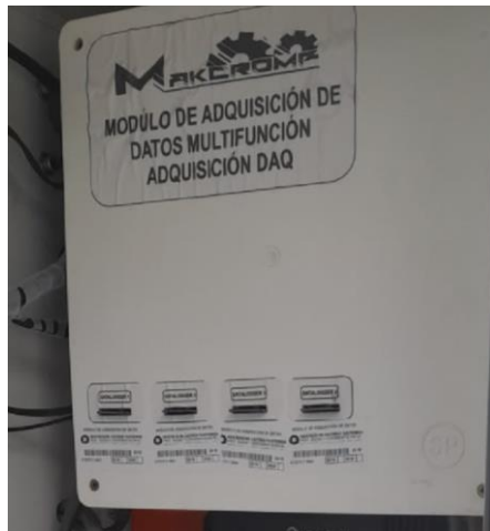
Figura 42. Dataloger usado para la recolección de datos
