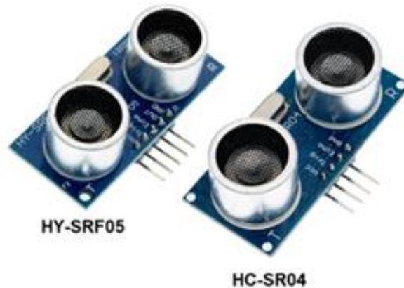
Figura 7. Sensores ultrasónicos HC-SR04 y HY-SRF05.
