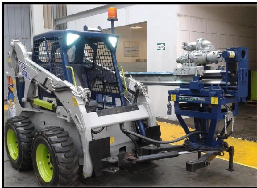
Figura 15: Perforadora diamantina subterránea modelo XRD40USS.
