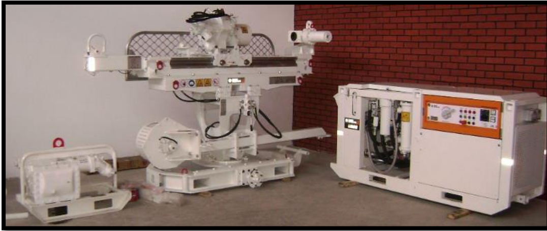
Figura 14: Perforadora diamantina subterránea modelo LM55U.
