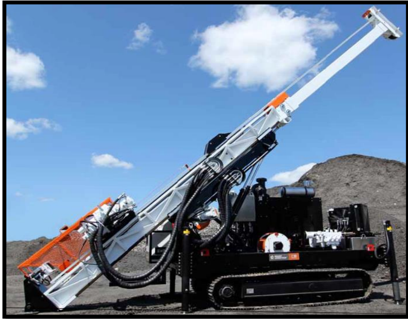
Figura 16: Perforadora diamantina superficie modelo LF90CT.
