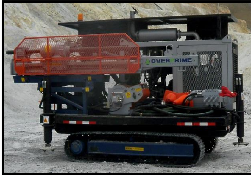
Figura 18: Perforadora diamantina superficie modelo XRD80ST.
