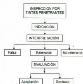
Imagen 1, diagrama de flujo de una inspección por tintes penetrantes.
