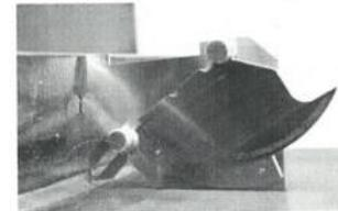
Fig. 6 Tomado de la geometría de cordones de fillet.
