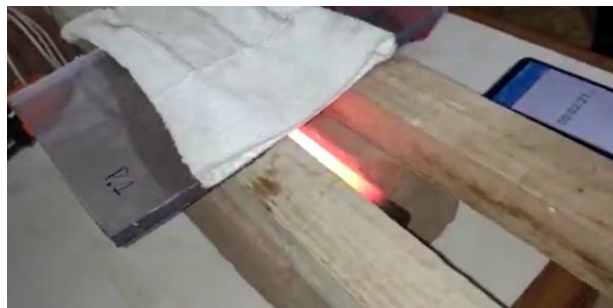
Figura 5.7. Prueba de doblado N°1
