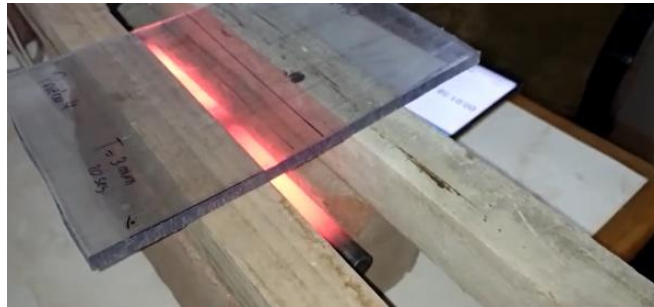
Figura 5.13. Prueba de doblado N° 4
