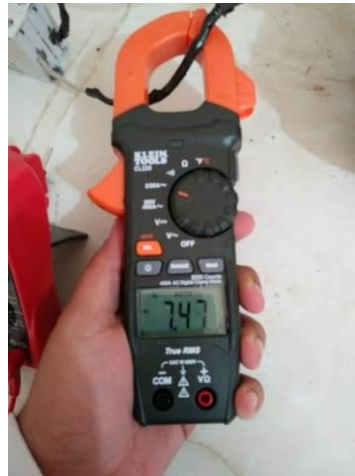
Figura 5.2. Medición de amperaje de operación
