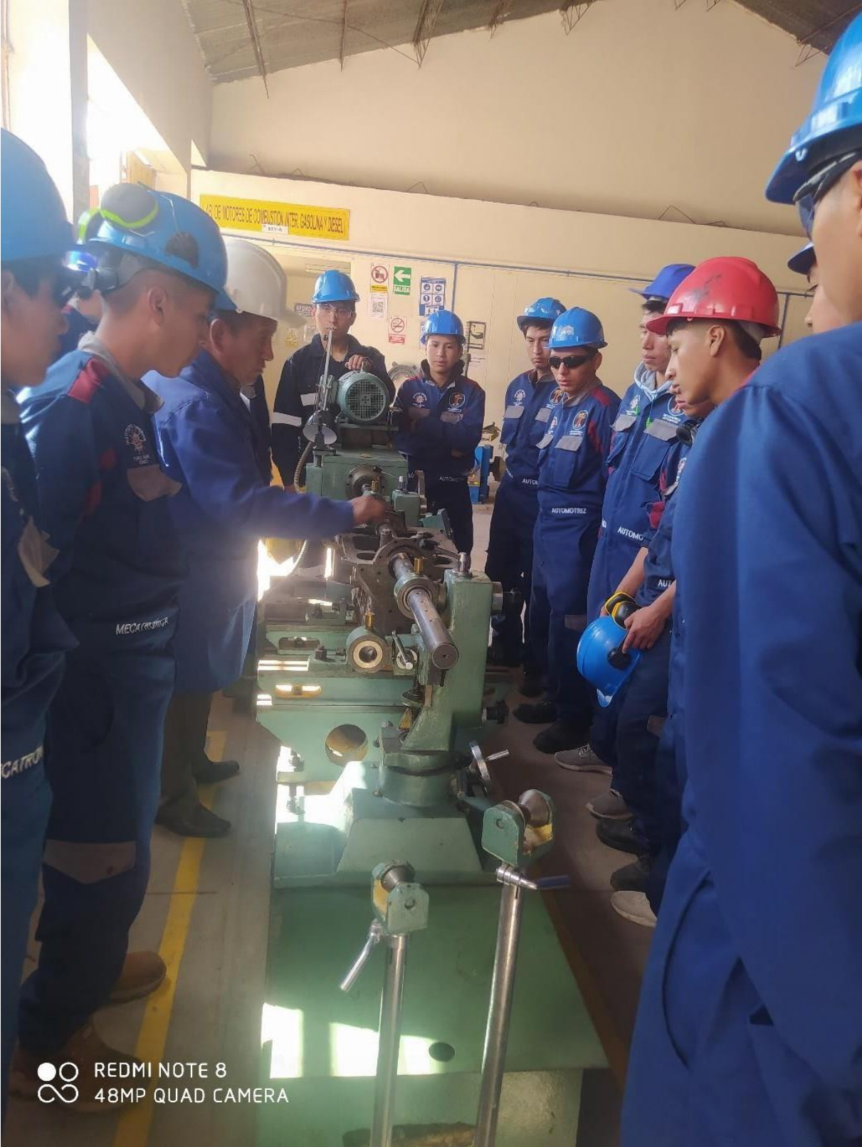
Figura anexo.8. Rectificadora de bancadas
