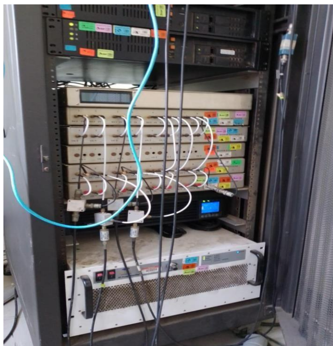
Fig. 42. Estructura interna del Radar ionosonda VIPIR (Generador de señales de radiofrecuencia, etapa de potencia, receptor de ecos ionosféricos).
