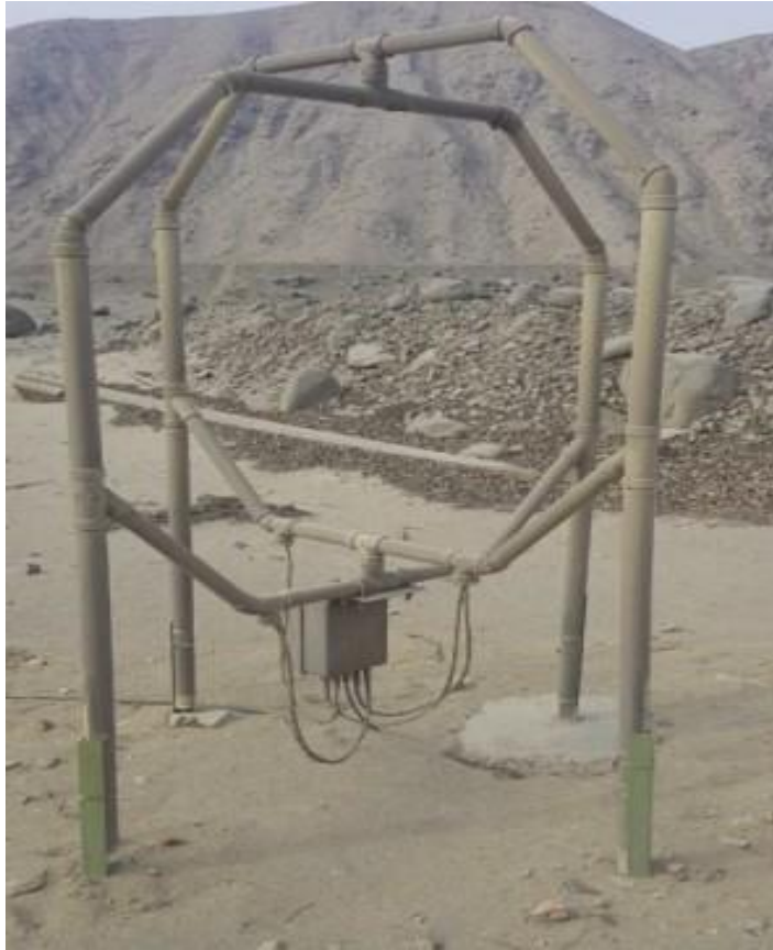
Fig. 3. Una de las 4 antenas receptoras del sistema DPS-4 [16].
