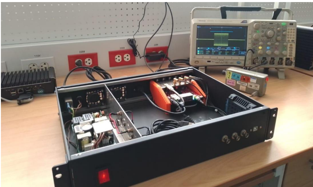
Fig. 55. Parte frontal del rack del generador de señales de radiofrecuencia para operar transmisor de radar ionosonda.
