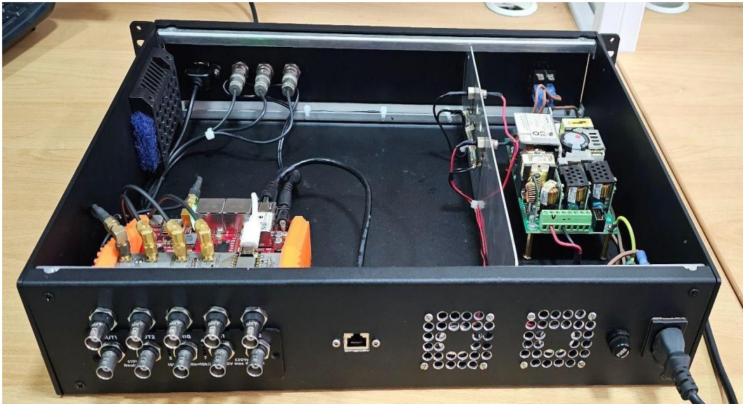
Fig. 54. Parte posterior del rack del generador de señales de radiofrecuencia para operar transmisor de radar ionosonda.
