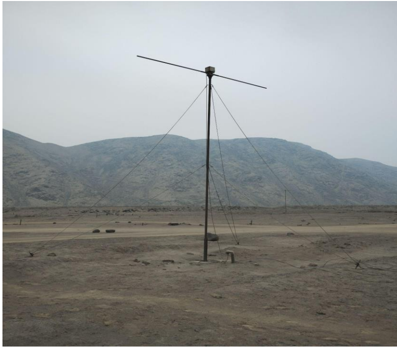
Fig. 46. Una de las ocho antenas dipolo del receptor de radar VIPIR.
