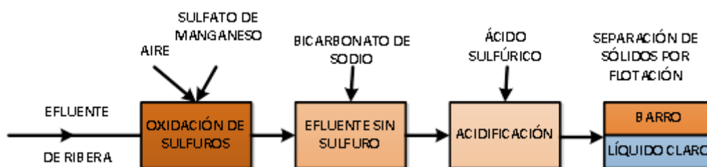
Figura 7 Tratamiento para eliminar el sulfuro zona ribera
