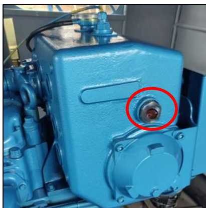
Figura 3.7. Tanque de expansión del motor
