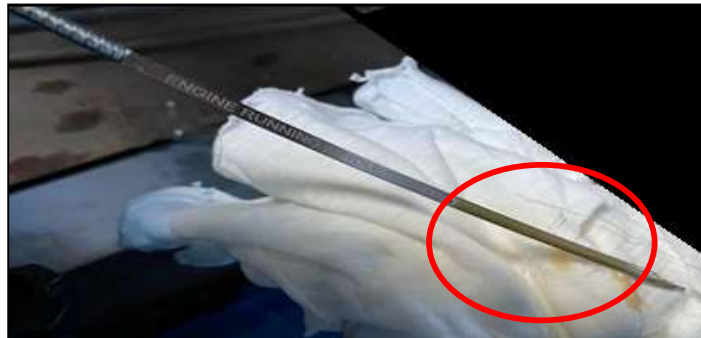
Figura 3.6. Varilla de aceite del motor
