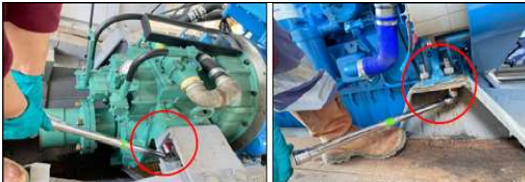
Figura 3.17. Ajuste de los pernos de las bases del motor y transmisión
