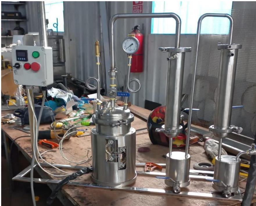
**C: Instalación del reactor de pirólisis alimentado con PET**
