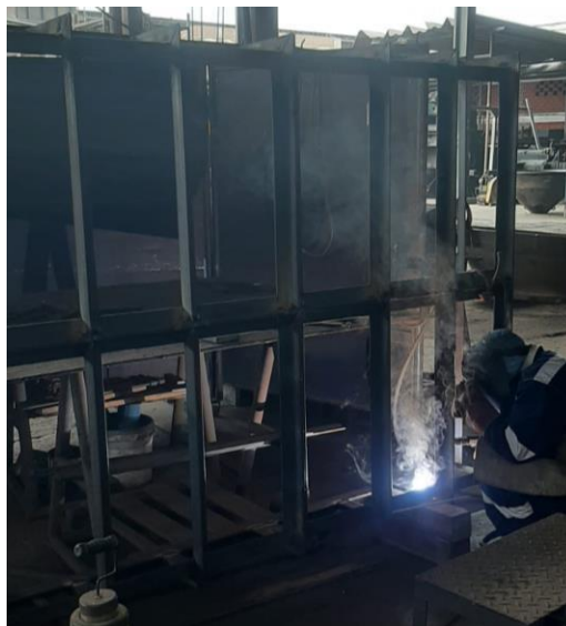
Figura 4.18 Soldeo de elementos
