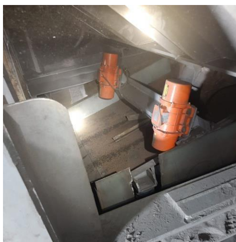
Figura 6.3 Zaranda vibratoria nueva
