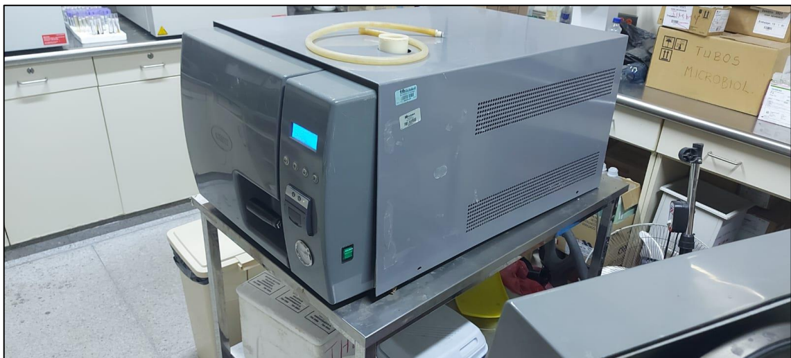
Figura N° 23. Equipo de autoclave para pruebas
