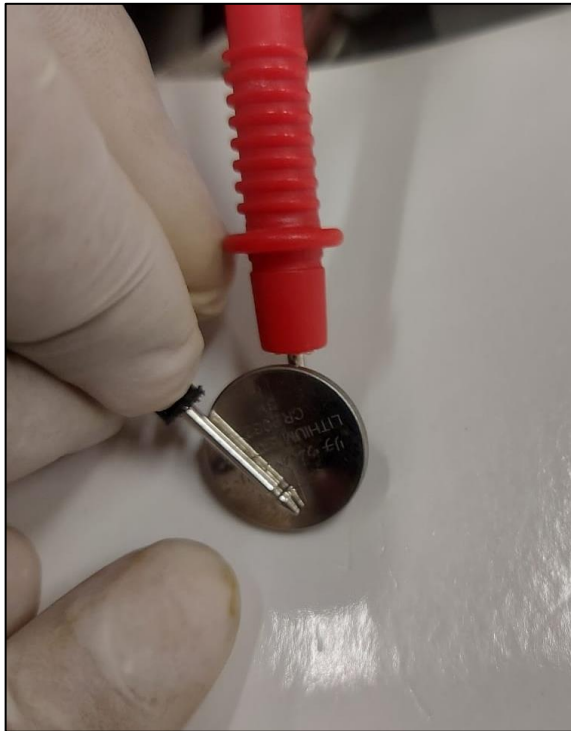
Figura N° 41. Medición de la pila
