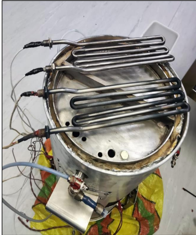
Figura N° 50. Cambio de resistencia interna Fuente: Elaboración propia
