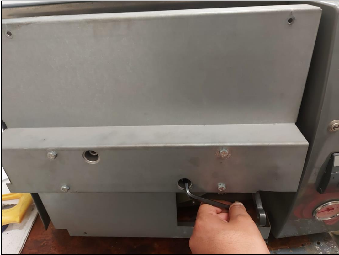
Figura N° 56. Calibración de la puerta de la autoclave
