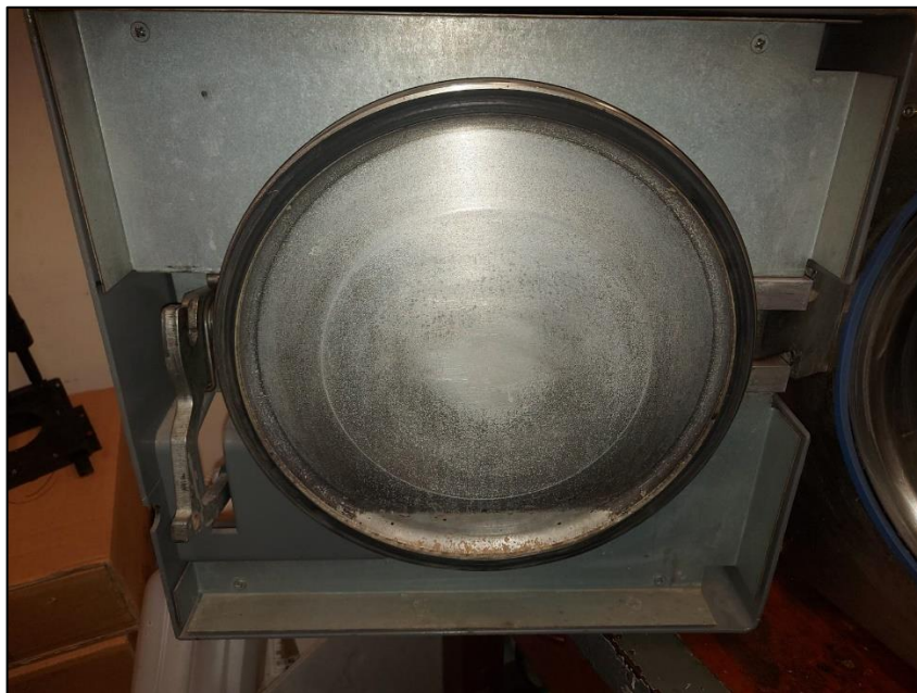
Figura N° 53. Cambio de la empaquetadura de la puerta Fuente: Elaboración propia
