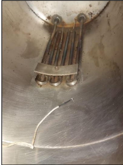
Figura N° 69. Colocación de la termocupla en el interior de la cámara
