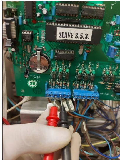
Figura N° 44. Medición de las señales de los solenoides Fuente: Elaboración propia
