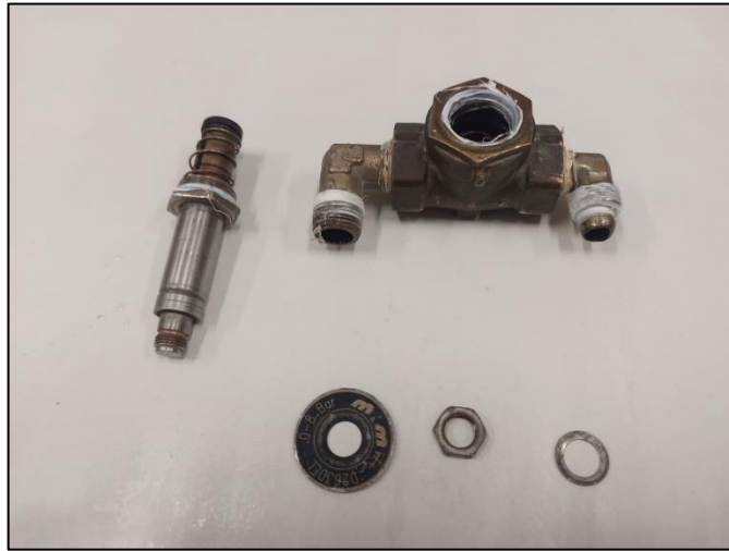
Figura N° 52. Cambio de la válvula solenoide Fuente: Elaboración propia
