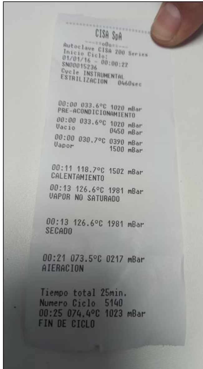
Figura N° 38. Resultado de impresión de prueba de funcionamiento, equipo con fallas
