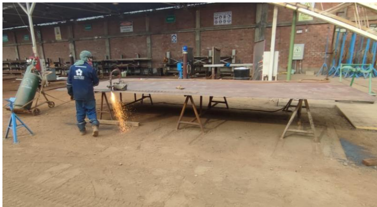
Figura 4.3 Habilitado de planchas por Oxicorte
