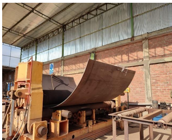
Figura 2.9 Rolado de planchas de tanque
