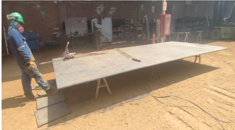
Figura 4.3 Habilitado de planchas por Oxicorte
