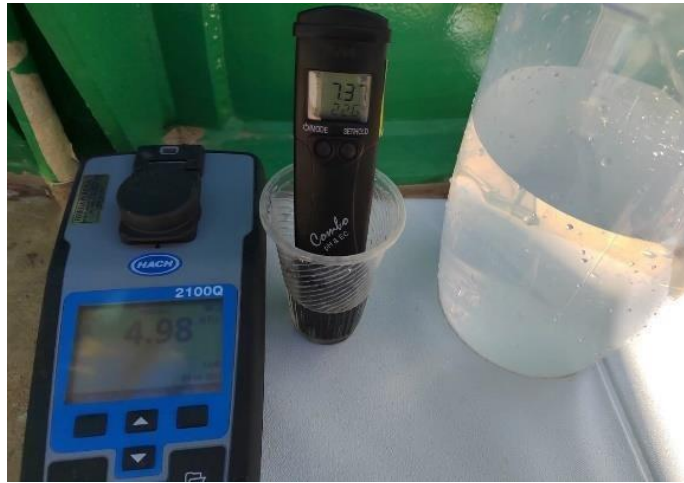
Figura 4.33 Registro de pH en cada etapa del tren de tratamiento principal
