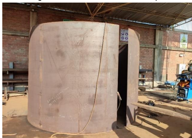
Figura 4.6 Armado de anillos de tanques
