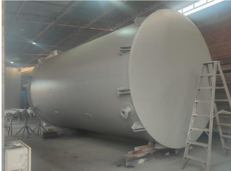
Figura 4.13 Tanque de neutralización en capa base
