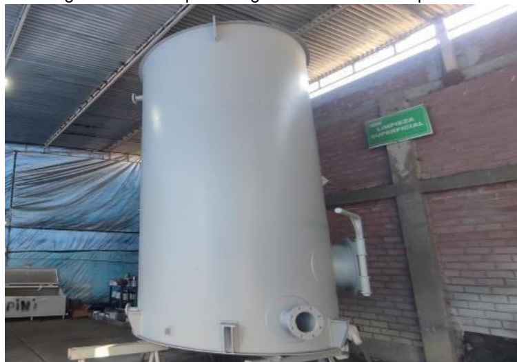
Figura 4.12 Tanque de agua clarificada en capa base
