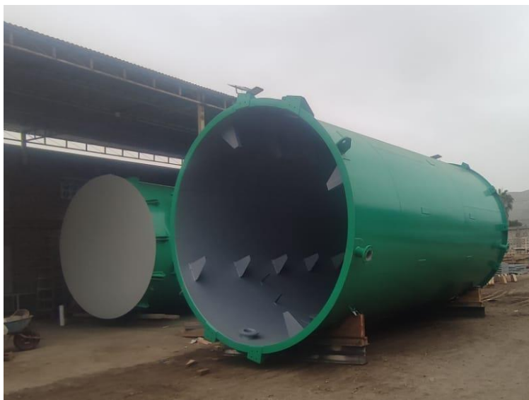
Figura 4.27 Tanques de neutralización y oxidación en capa acabado
