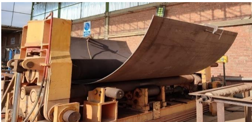
Figura 4.6 Armado de anillos de tanques
