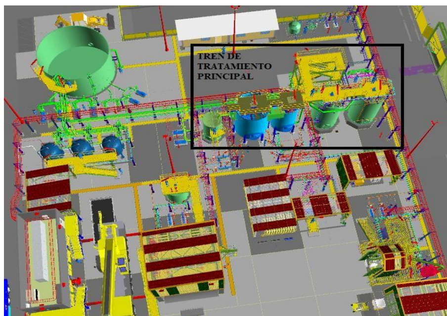
Figura 4.3 Maqueta de Planta de tratamiento de aguas ácidas, elaborado por Unidad Minera Shahuindo 2020
