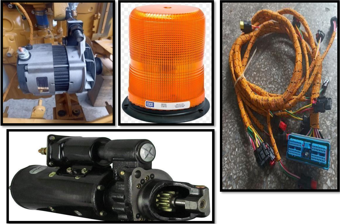
Figura 4.24 Elementos reparados del sistema eléctrico
