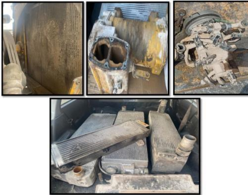
Figura 4.3 Conjunto de Fallas de Sistema Refrigeración
