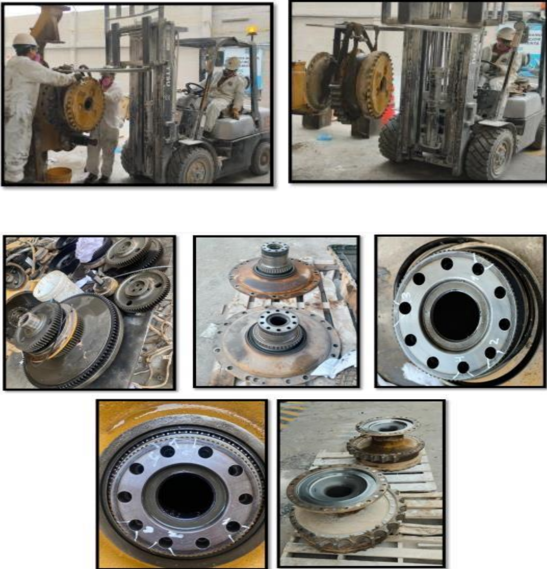
Figura 4.18 Conjunto de Fallas Mando final derecho / Izquierdo
