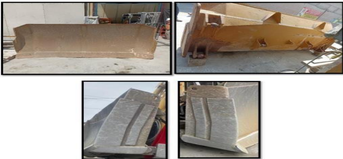
Figura 4.14 Conjunto de Fallas de la Hoja Topadora
