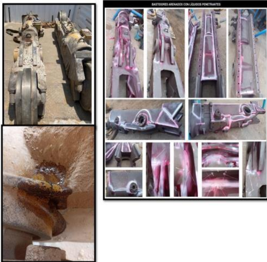
Figura 4.12. Conjunto de Fallas del Bastidor derecho
