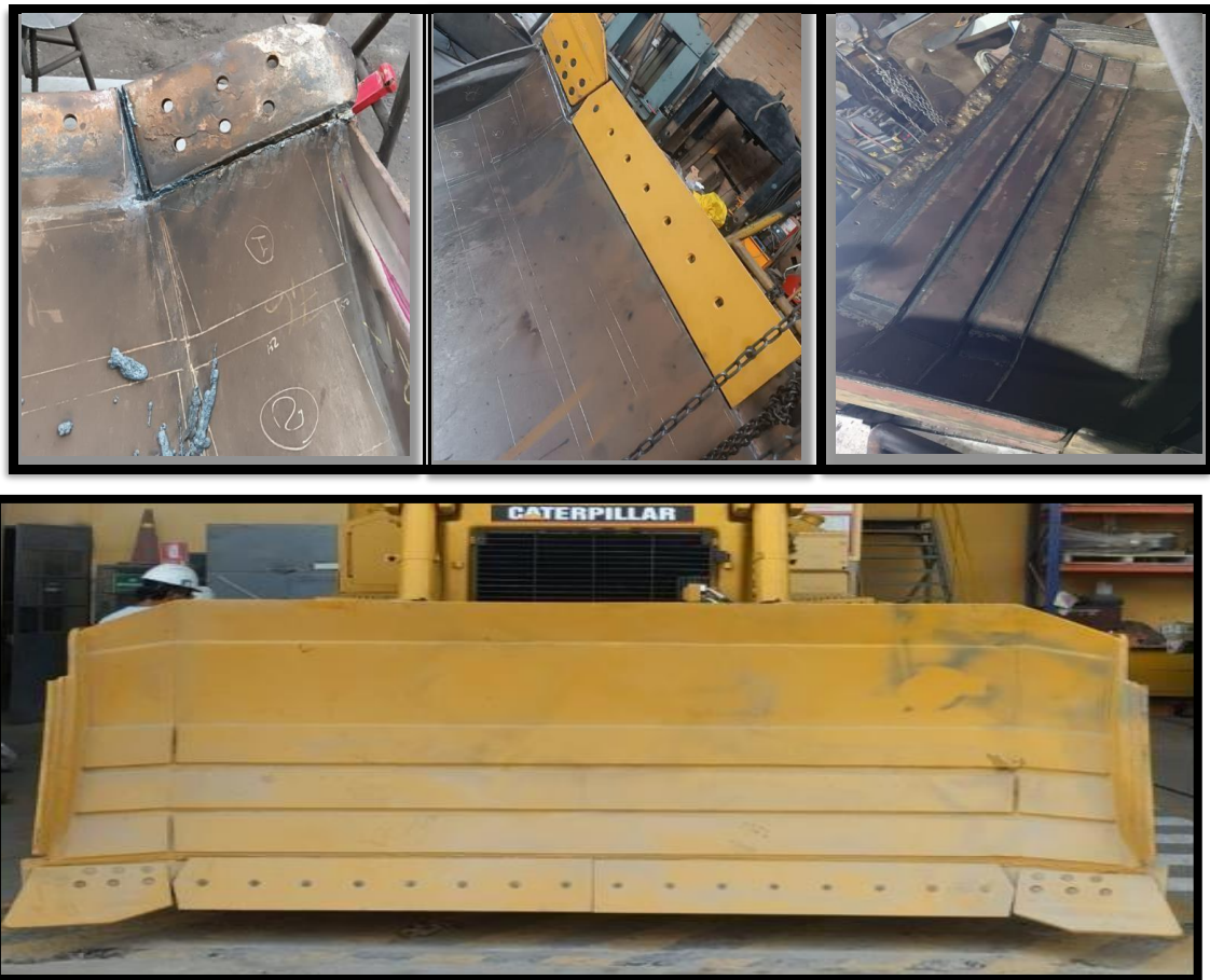
Figura 4.26 Elementos reparados de la hoja topadora.
