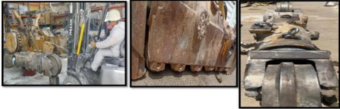
Figura 4.11 Conjunto de Fallas del Sistema de Bastidor.
