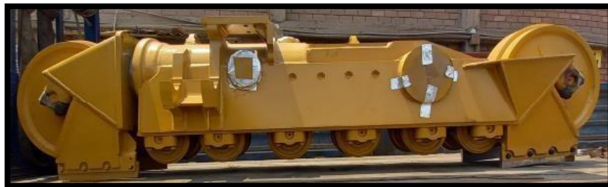
Figura 4.28 Elementos reparados bastidor de oruga derecho e izquierdo.
