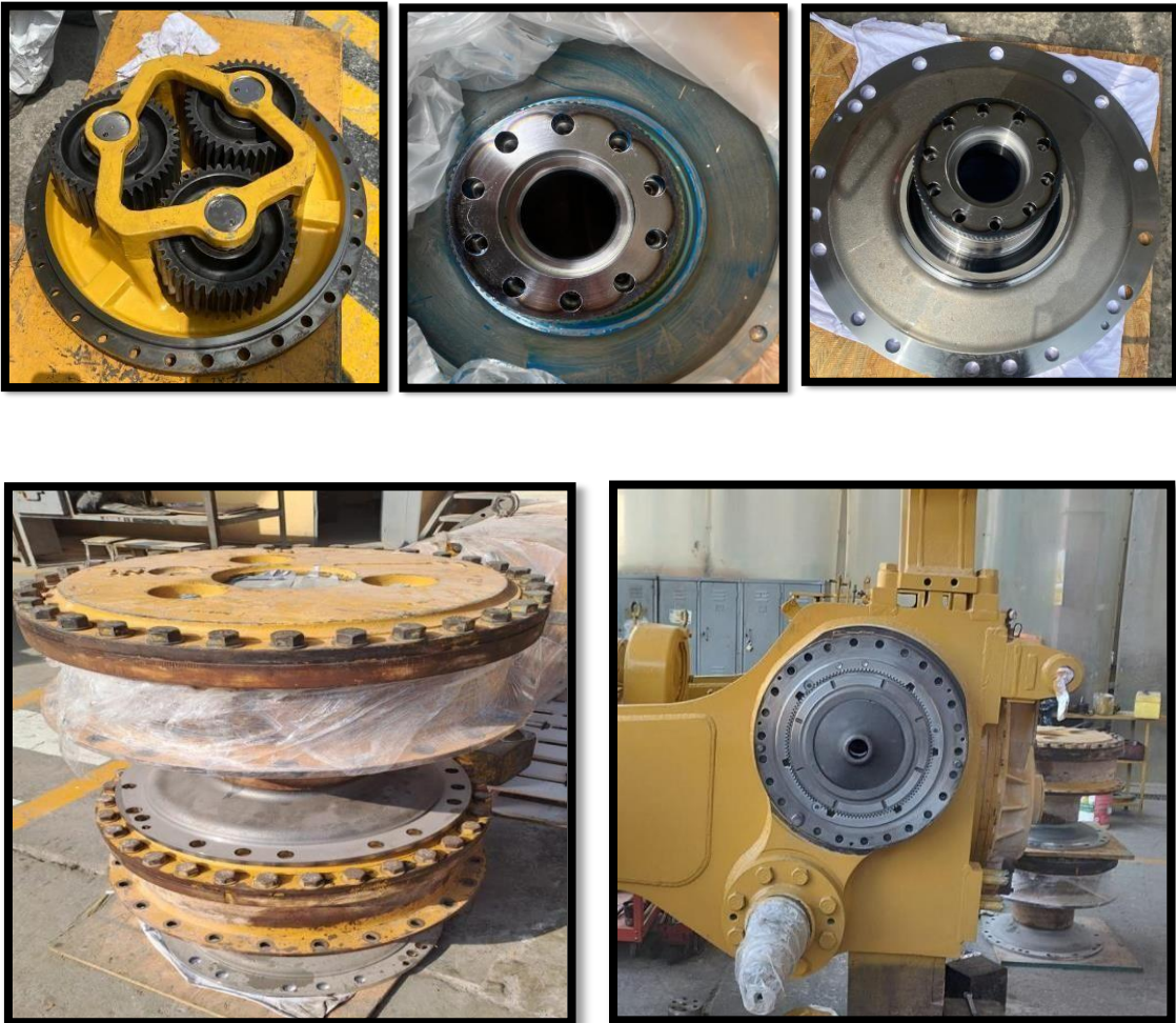
Figura 4.30 Elementos reparados mandos finales derecho e izquierdo.
