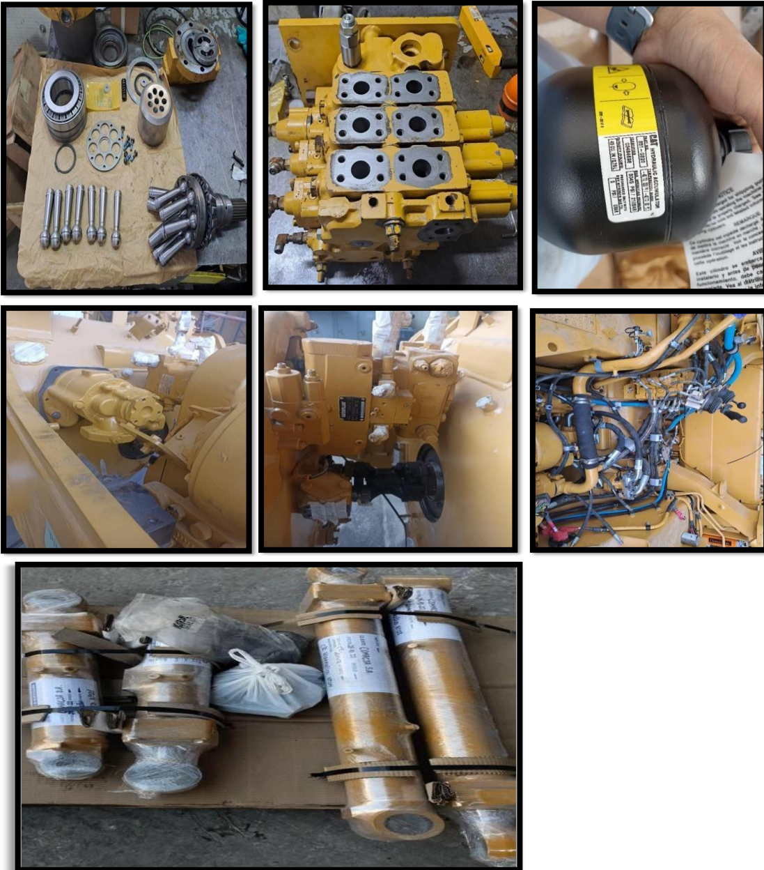
Figura 4.22 Elementos reparados del sistema hidráulico
