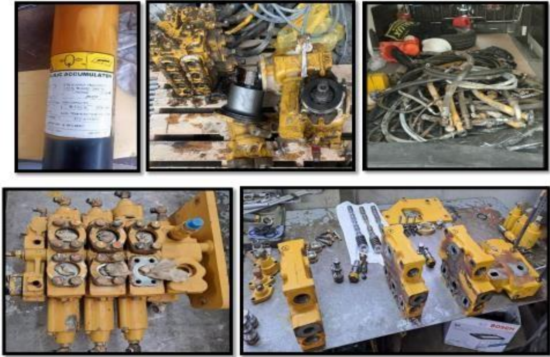
Figura 4.7 Conjunto de Fallas de Sistema Hidráulico
