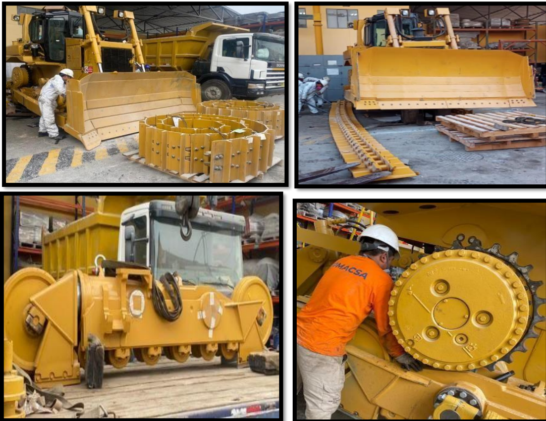
Figura 4.25 Elementos reparados de la carrilería.
