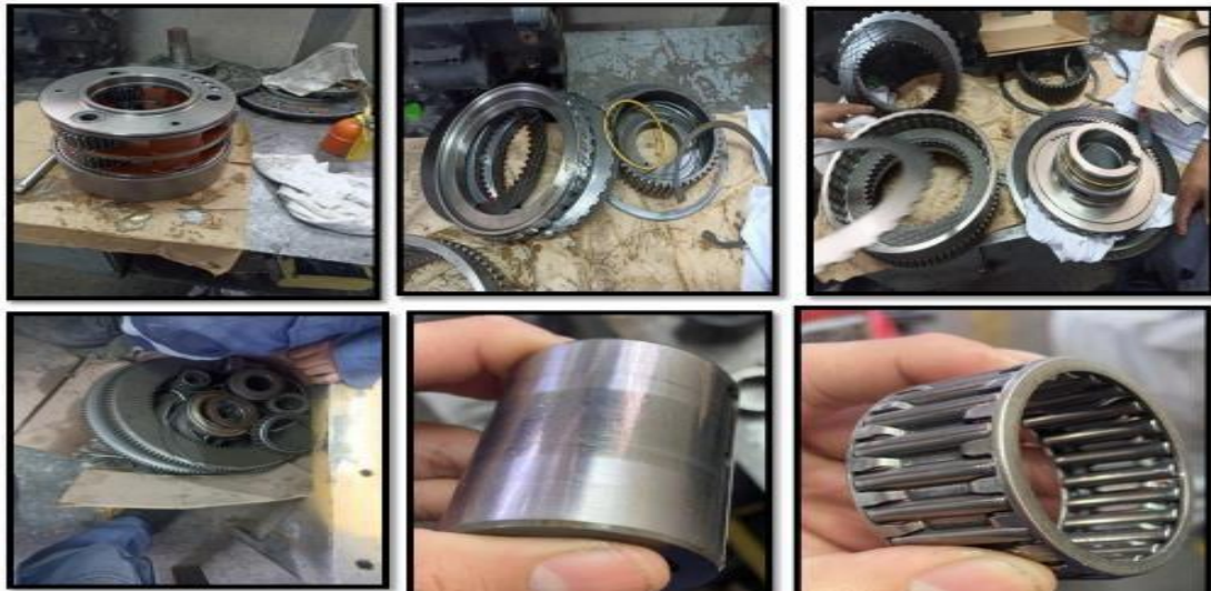
Figura 4.19 Conjunto de Fallas Freno de servicio y freno de emergencia
