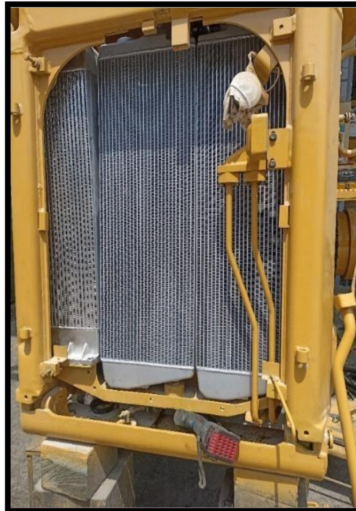
Figura 4.21 Elementos reparados del sistema refrigeración
