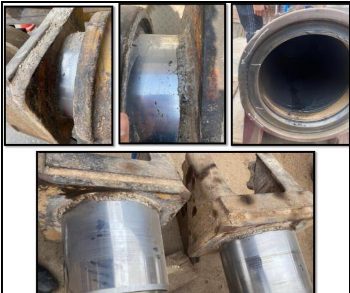
Figura 4.13 Conjunto de Fallas del Telescópico Derecho e Izquierdo
