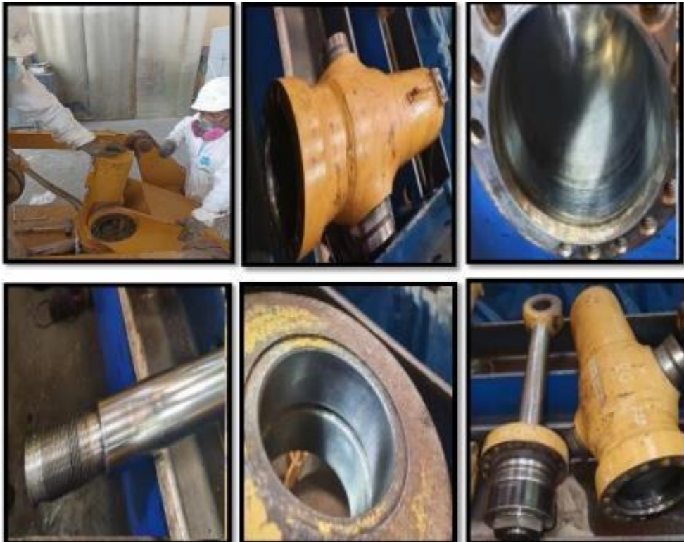
Figura 4.4 Conjunto de Fallas de Sistema Hidráulico – Cilindro de Ripper
