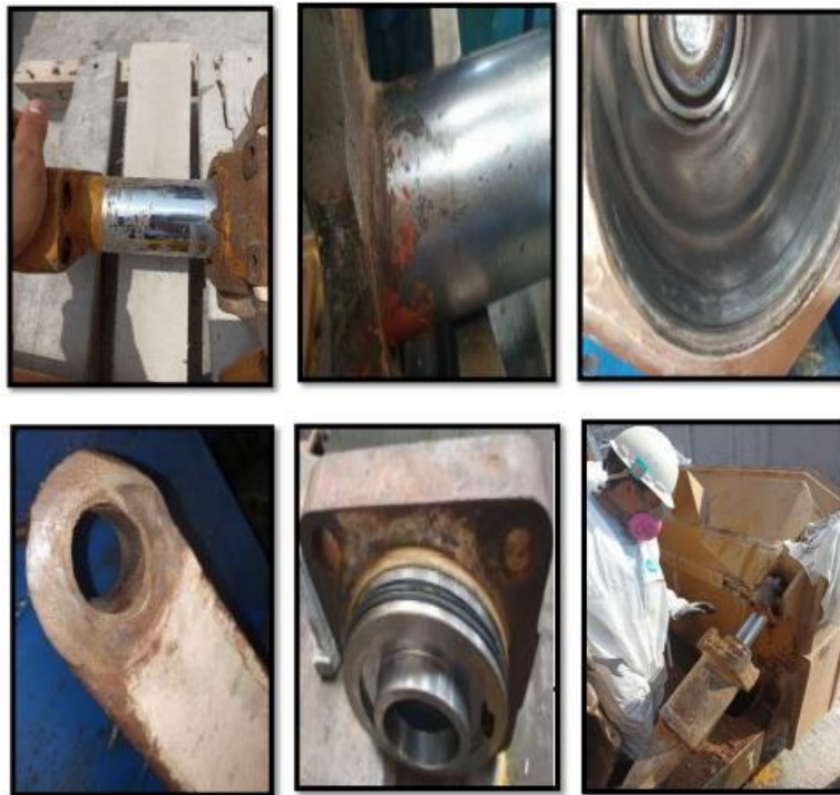
Figura 4.5 Conjunto de Fallas de Sistema Hidráulico – Cilindro de Angulación
