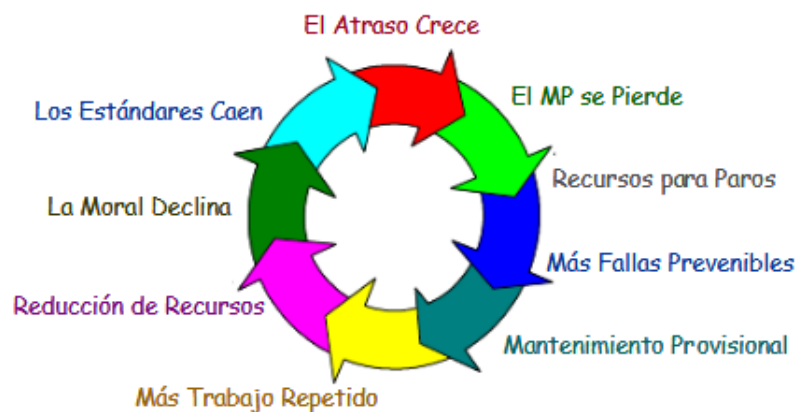
Figura 2.6. Ciclo reactivo del mantenimiento
