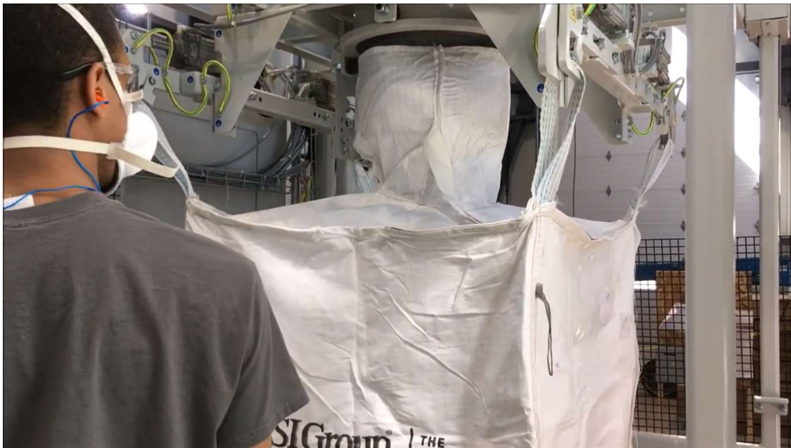
Figura N° 3.24. - Sistema de llenado de bolsas de Big Bag de 1000Kg – Semi automática para productos abrasivos y polvorientos
