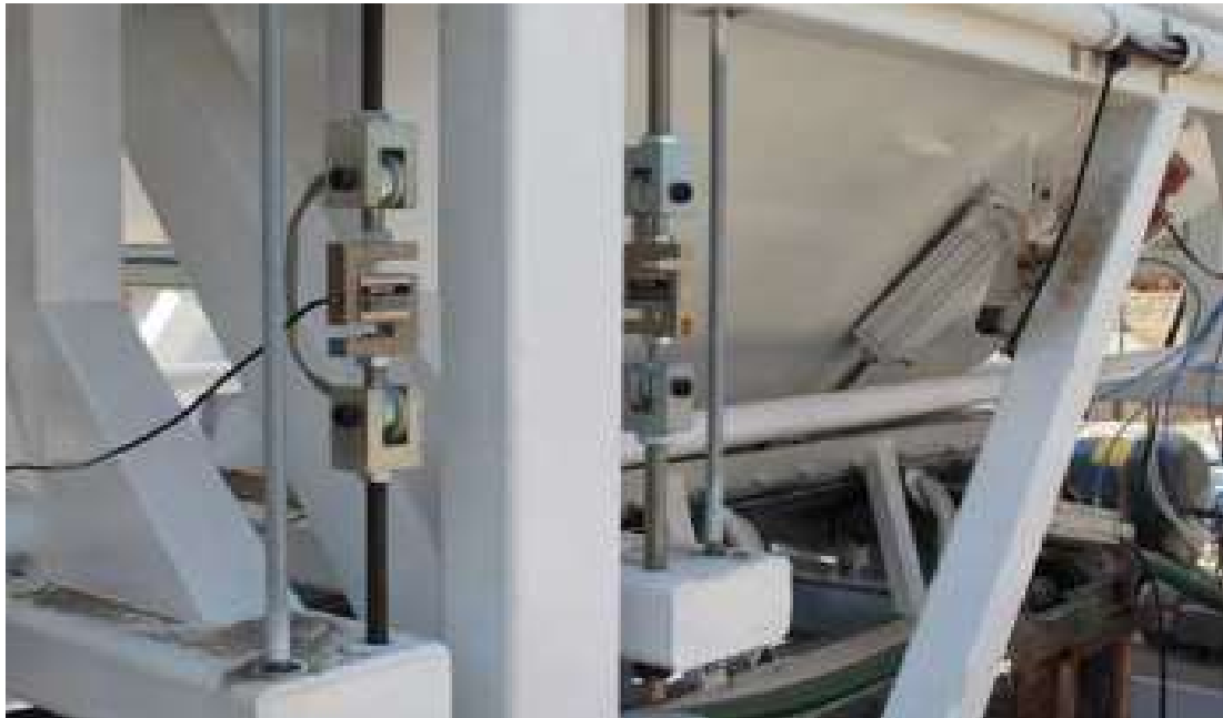
Figura N° 2.11. - Tolvas Pesadoras para material a granel – celdas tipo “S”.
