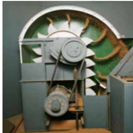
Figura N° 2.3. – Cabezal de elevador de cangilones - Vista de descarga por gravedad.
