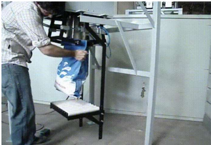
Figura N° 3.23 - Llenadora de bolsas de 20-50 Kg – semi automatica para productos abrasivos y polvorientos.
