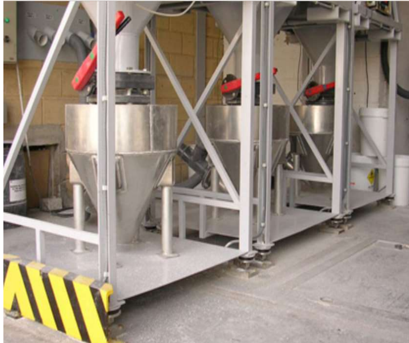
Figura N° 2.10. -Tolvas Pesadoras para Granjas – Basculas Costa.
