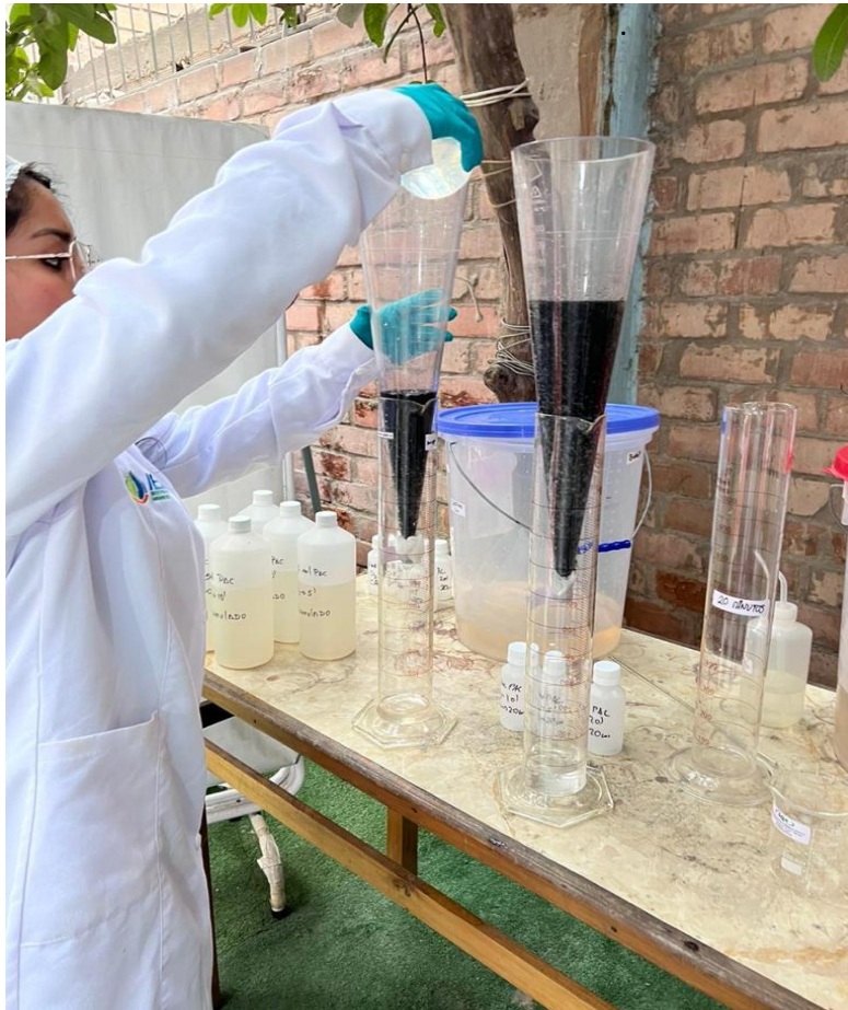
Figura 12 Proceso de filtración con carbón activado a una altura de 20 y 30 cm.
