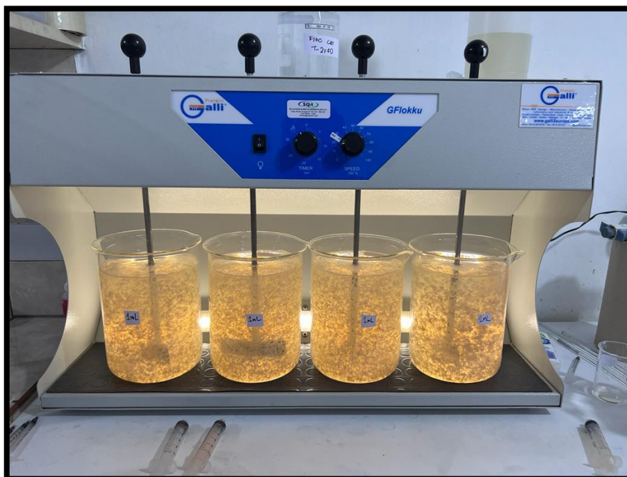
Figura 22 Etapas de coagulación – floculación, formación de flocs
