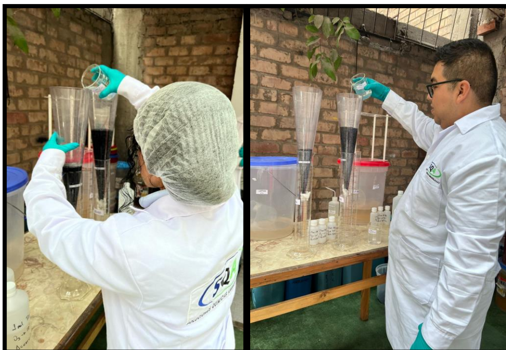
Figura 26 Filtración con carbón activado
