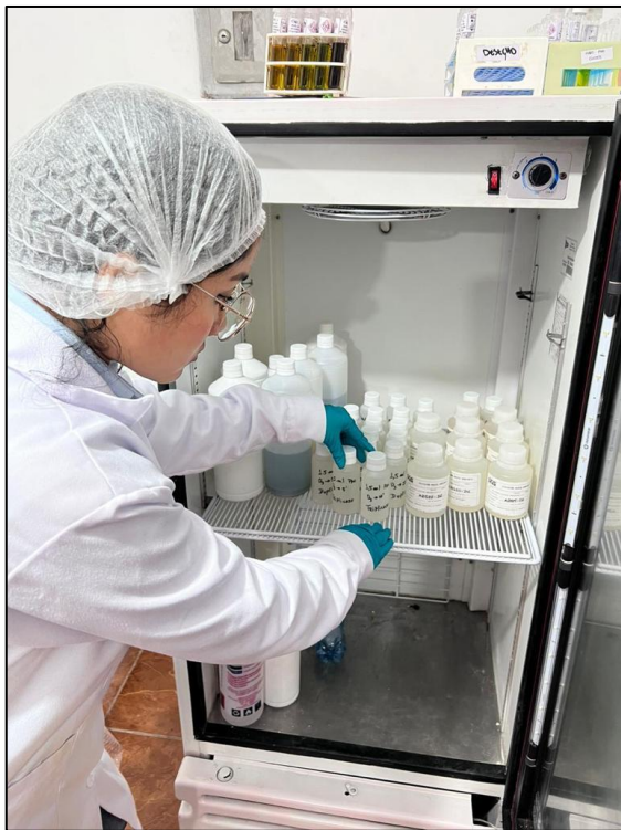
Figura 7 Conservación de la muestra para análisis de DBO5.
