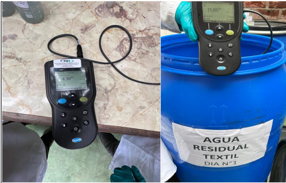
Figura 9 Caracterización inicial de pH y acondicionamiento a pH 11
