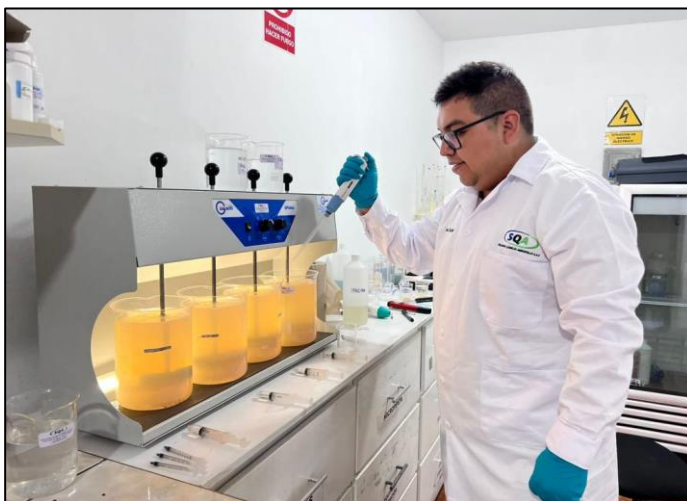
Figura 10 Pruebas de Jarras para tratamiento de agua residual textil mediante coagulación – floculación.
