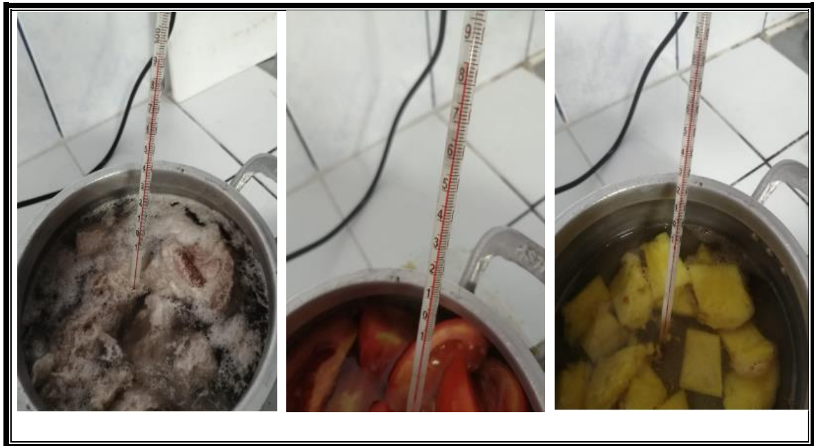
Figura: toma de temperatura de la materia prima en el proceso de blanqueado - escaldado
