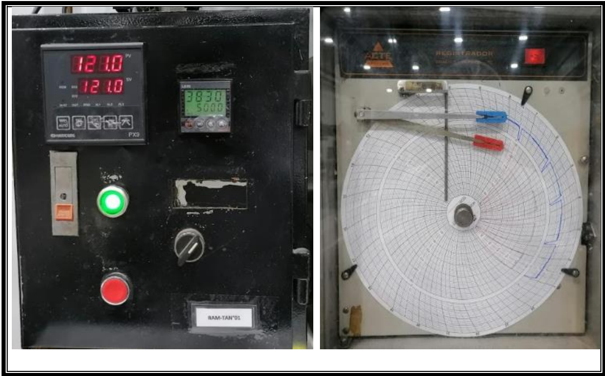
Figura: temporizador y medidor de temperatura del autoclave durante el proceso de esterilización
