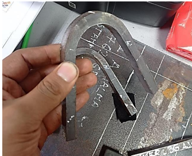
Imagen 3.1 Probetas dobladas lateralmente
