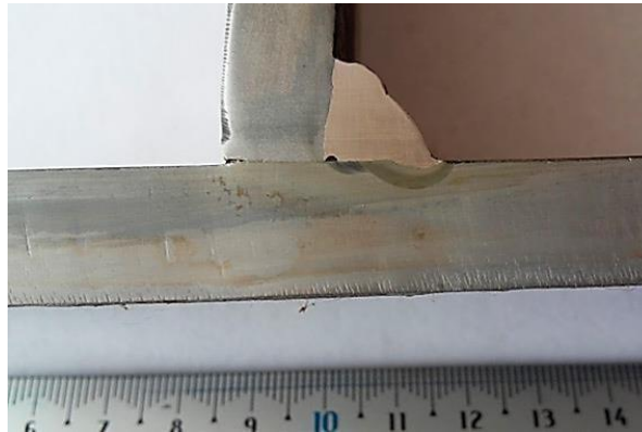
Imagen 2.6 Ensayo de macroataque
