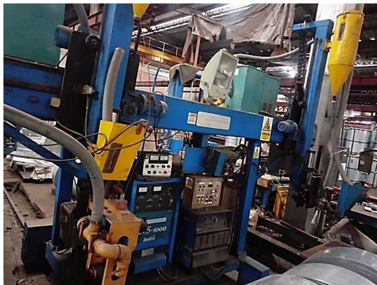
Imagen 3.7 Máquina de soldar para el proceso SAW
