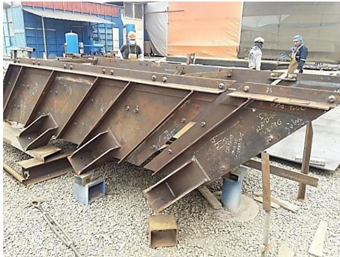
Imagen 2.3 Chute para operación minera
