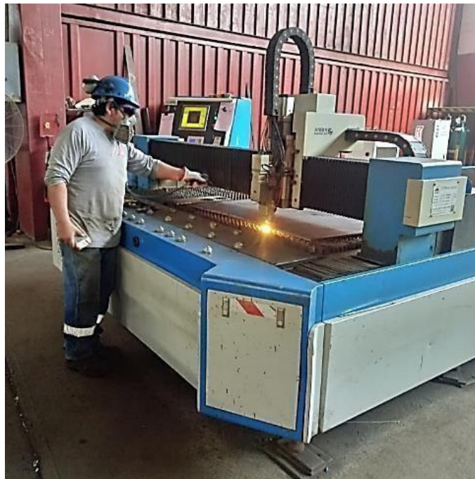
Imagen 3.3 Corte láser de placas para conexión a la roca
