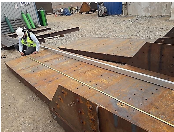
Imagen 3.6 Medición de la longitud de una cota principal del subensamble EG.01.SD.25.B del chute 25
