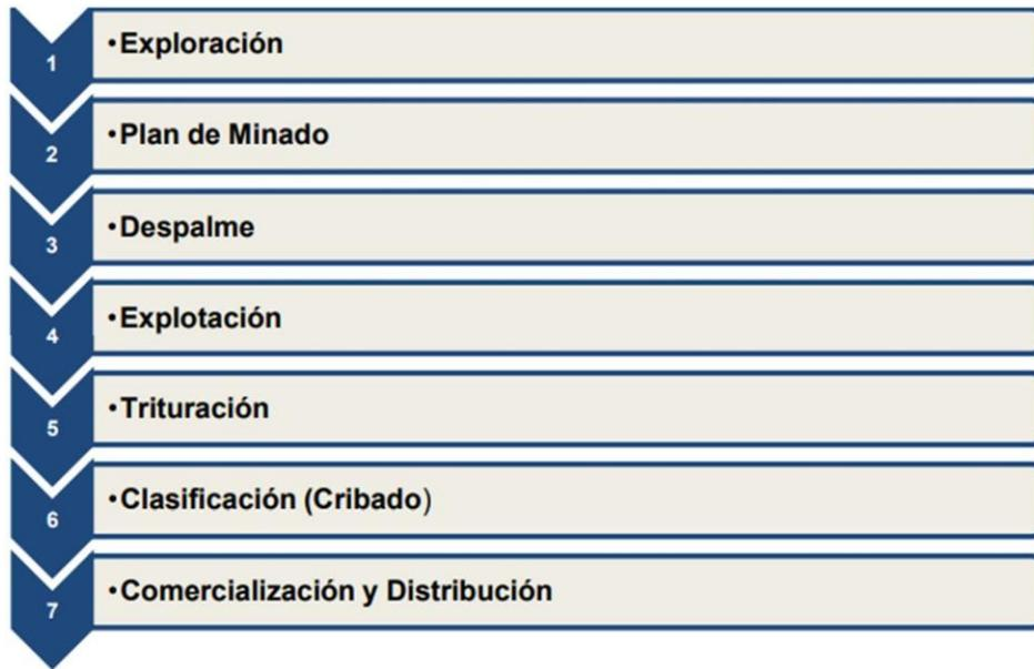
Figura 5. Etapas de la producción de agregados. Tomado de: Procesos de producción de agregados pétreos y su control de calidad, por Olguín (2016)
