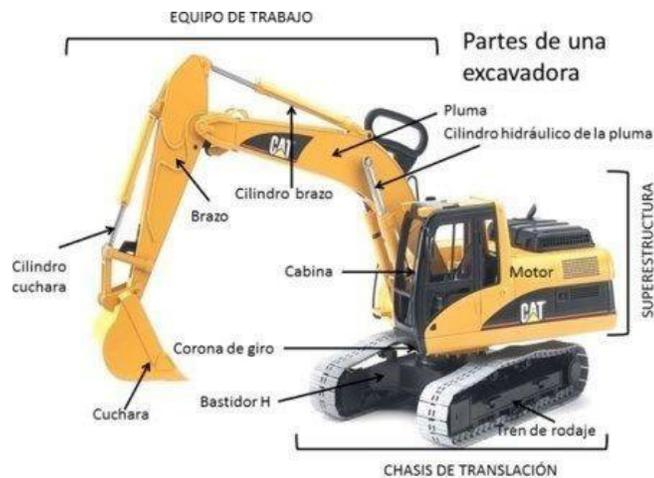
Figura 12. Partes de la excavadora. Tomado de “Manual del usuario de la Excavadora Hidráulica CAT 330 GC”, por CAT (2020)
