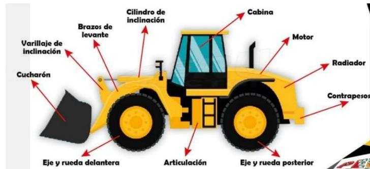
Figura 11. Partes del cargador frontal. Tomado de “Seminario Cargador Frontal”, por Clemente (2020)
