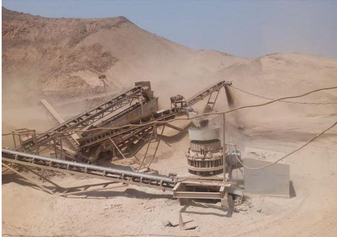
Figura 22. Trituradora cónica foto real en cantera. Nota: Elaboración propia
