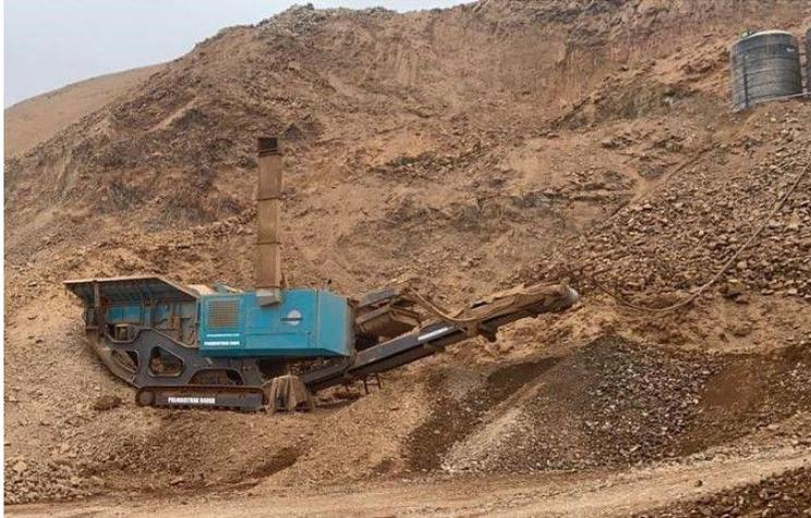
Figura 20. Trituradora primaria de mandíbula foto real en cantera. Nota: Elaboración propia
