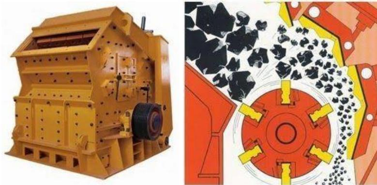
Figura 7. Trituradoras de impacto. Tomado de: Tituradoras de impacto, por Miranda (2016)
