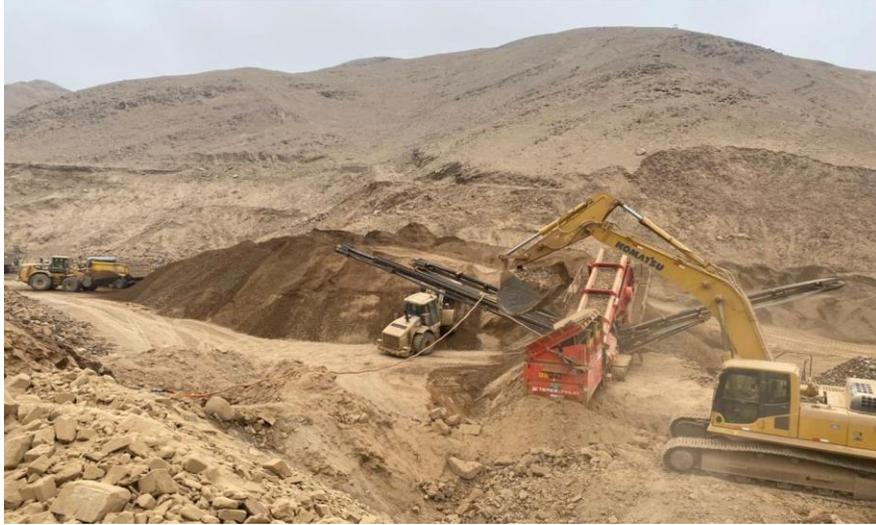
*Figura 26.* Línea de producción material Subbase foto real cantera. Nota: Elaboración propia
