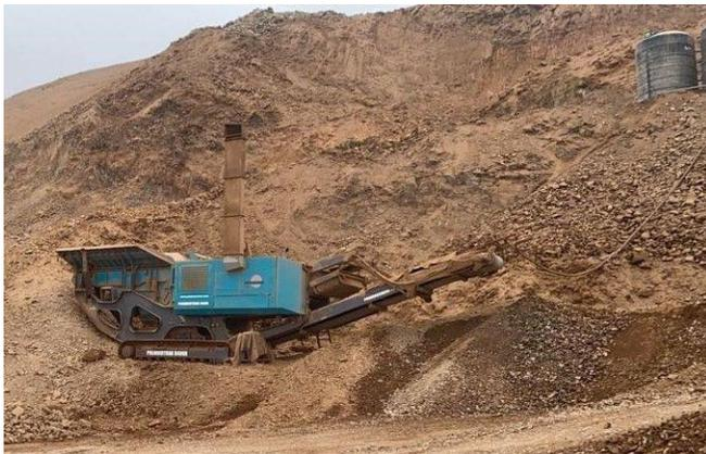
*Figura 19.* Trituradora primaria de mandíbula foto real en cantera. Nota: Elaboración propia
